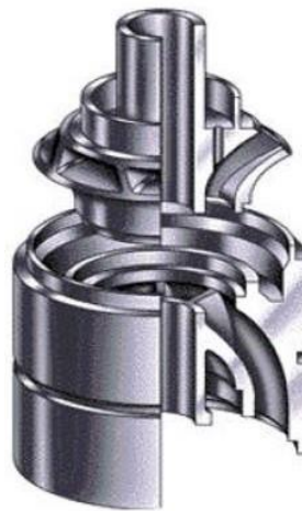
Figura 20.- Impulsor tipo mixto. Fuente: Extraído de [17]
