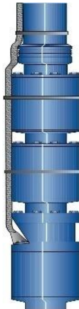
Figura 23.- Flejes a lo largo de la tubería de producción. Fuente: Extraído de [18]
