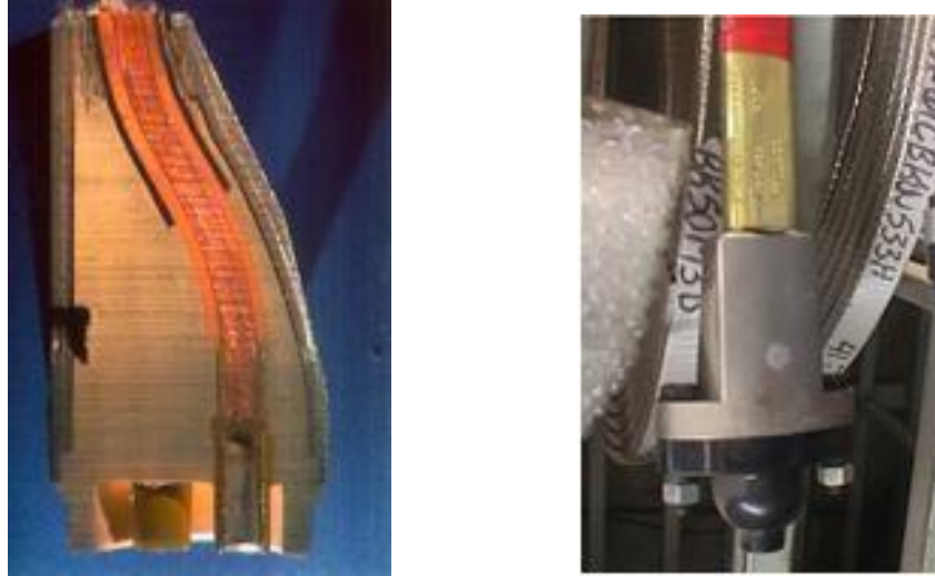
Figura 22.- Cable de extensión del motor (MLE). Fuente: Extraído de [18]
