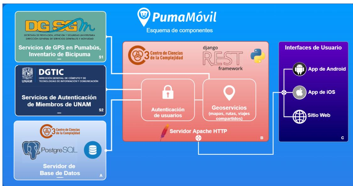
Figura 3.1: Diagrama de sistemas componentes de la aplicación. Imagen elaborada por el autor.
