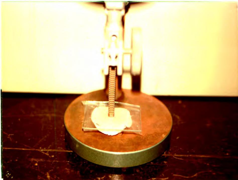
6, Foto.- Se observa la hoja de polietileno, el plato de vidrio y la masa plástica de acrílico.
