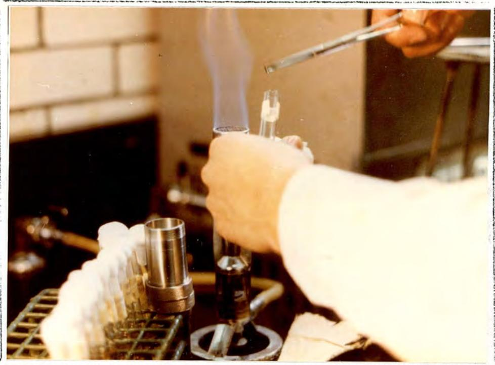
FIG. 7.- LIMAS COLOCADAS EN TUBO DE ENSAYE CON INFUSION CEREBRO-CORAZON ANTE EL MECHERO DE BUNSEN.
