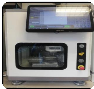
Figura 53 Fresado de coronas provisionales en el disco PMMA
