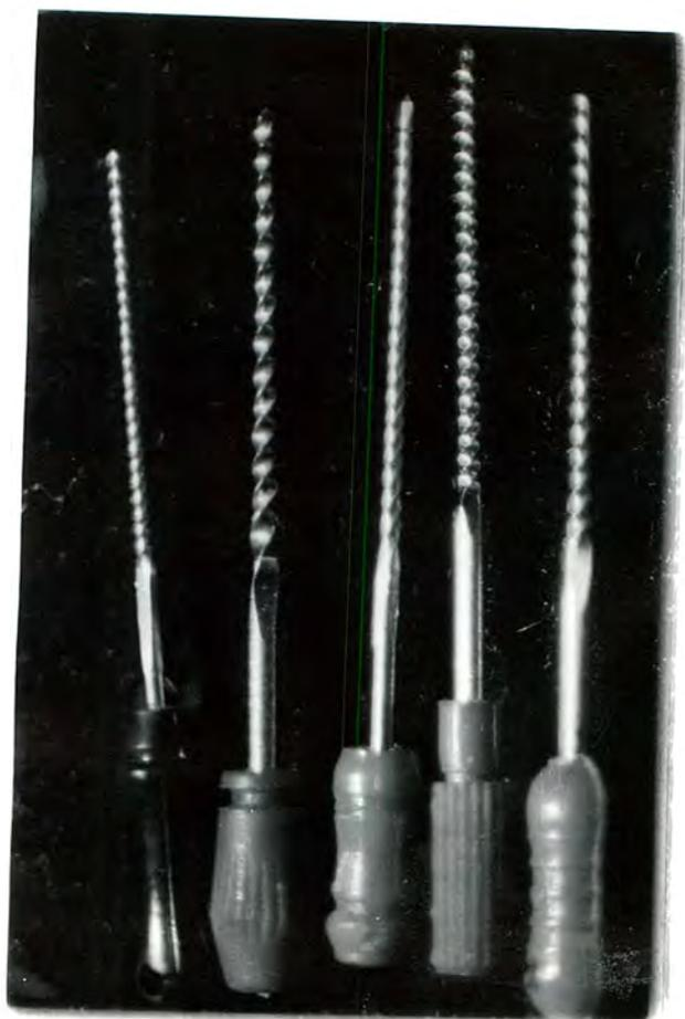
Foto No. 4 LAS LIMAS DE DIFERENTES MARCAS ANTES DE ENTRAR A LA SOLUCION DE SULFATO DE COBRE.
