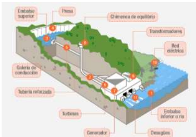
Figura 5. Sistema de una central Hidroeléctrica (Iberdrola, 2016).
