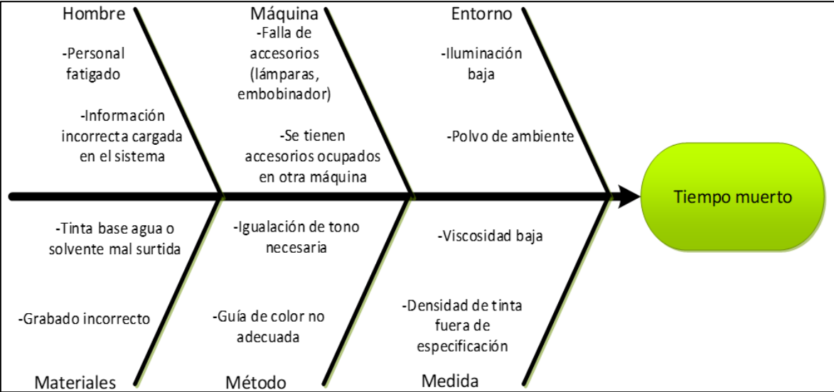
Figura 4.4 Diagrama de Ishikawa con las causas que originan el tiempo muerto. Fuente: elaboración propia, 2020.
