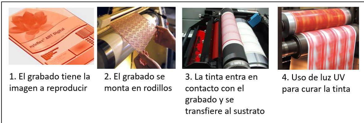
Figura 2.3 Proceso resumido de impresión flexográfica. Fuente: elaboración propia.
