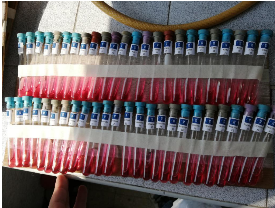
Figura 9. Preparación a 45 ° de los tubos para la técnica de Matsukubo
