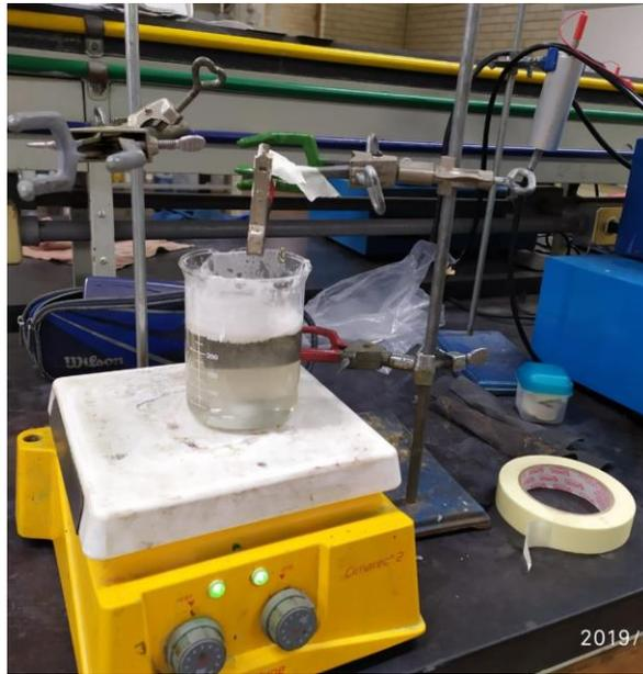
Figura 4. 2 Sistema de pavonado chileno (caliente).
