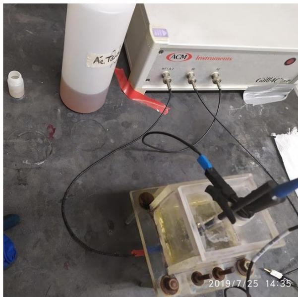
Figura 4. 3 Celda utilizada para las evaluaciones electroquímicas.
