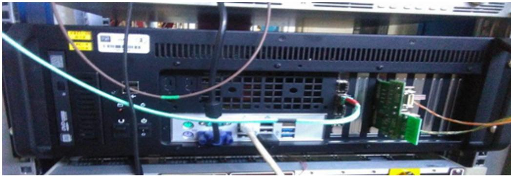
Figura 2.24: Fotografía de la computadora principal vista desde atrás con sus respectivas conexiones de VGA al monitor, un cable ethernet a la segunda computadora, el módulo EXPLODER y el cable de alimentación.
