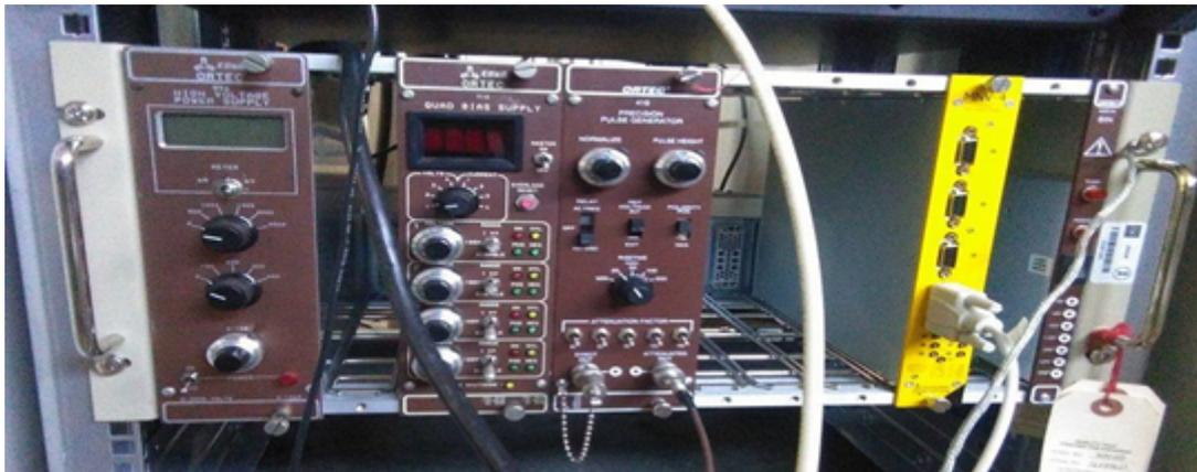
Figura 2.21: Fotografía de las fuentes de alimentación para un fototubo (izquierda), fuente del detector y generador de pulsos (centro) y fuente del preamplificador (derecha).
