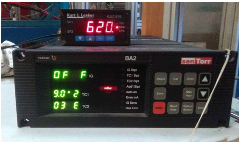
Figura 2.25: Fotografía del medidor de vacío conectado a la línea del acelerador Van de Graaff del Instituto de Física, UNAM.
