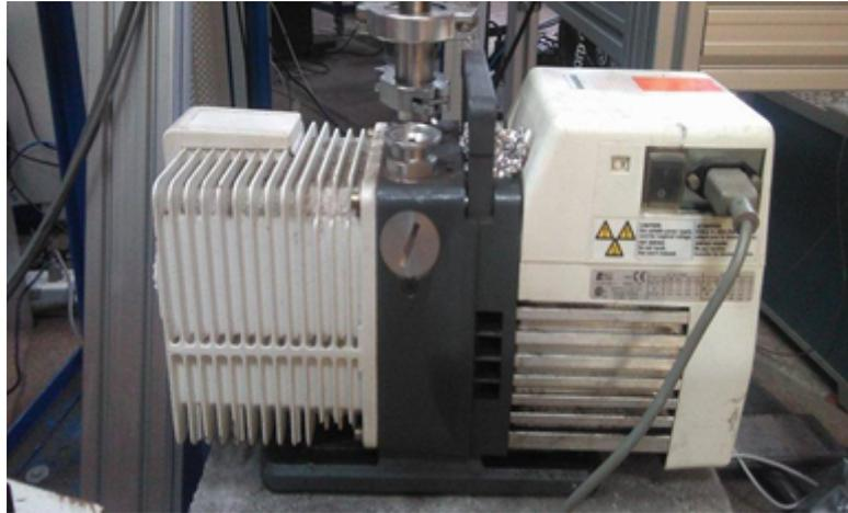
Figura 2.18: Fotografía de la bomba mecánica de vacío de la línea del acelerador Van de Graaff del Instituto de Física, UNAM.
