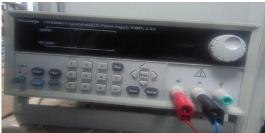
Figura 2.23: Fotografía de la fuente Tektronix PWS4602 de alimentación del módulo EXPLODER.
