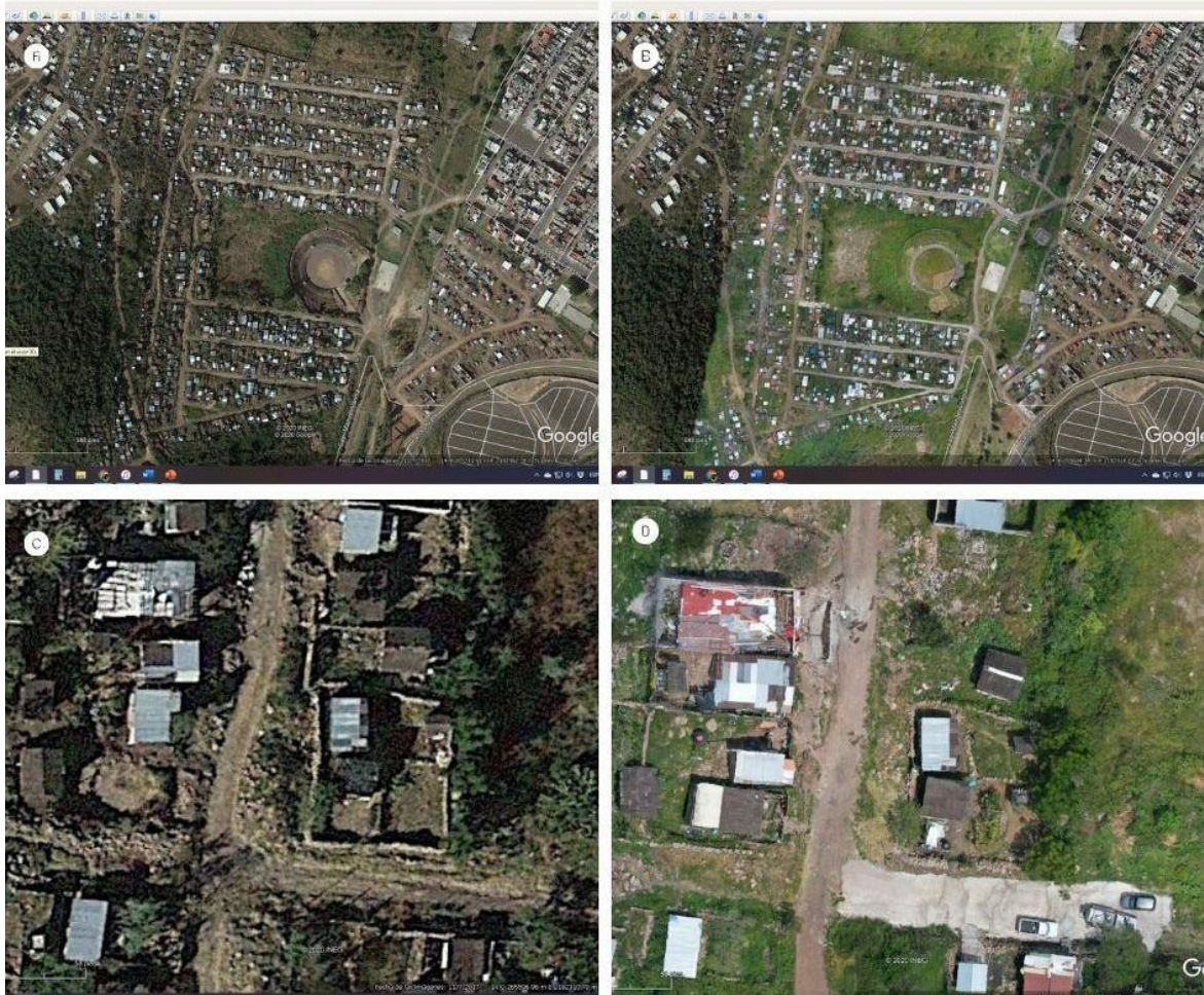
Figura 16. Asentamiento irregular ubicado en la periferia de la ciudad de Morelia, Michoacán., A y C) captura de pantalla extraída el 11/05/2020 de Google Earth (fecha de la imagen 11/07/2017) y acercamiento de la imagen, esto muestra que la información disponible de esta zona y en esta plataforma no es reciente, B y D) Ortomosaico sobrepuesto en Google Earth generado con Phantom 4 Pro (septiembre 2019), y acercamiento de la imagen (Fuente: Acervo fotográfico del LUD. Elaboración propia).
