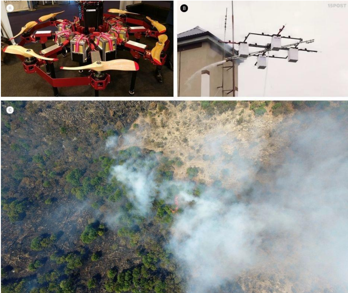
Figura 13. Los drones y su relación con los incendios. , A) dron para apagar incendios capaces de transportar hasta 300 litros de agua nebulizada, B) dron conectado a una manguera que le suministra agua y otra que le da energía para mantener el vuelo mientras se apaga el incendio ( Fuente: Imágenes tomadas de internet), y C) fotografía capturada al momento de producirse un incendio forestal en las cercanías de la UNAM Campus Morelia ( Fuente: Acervo fotográfico del LUD. Elaboración propia).
