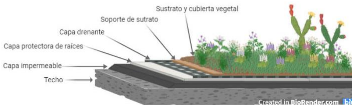
Figura 3. Capas estructurales de una azotea verde (Creado en la página Biorender.com).
