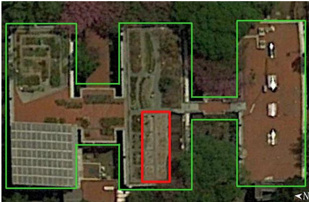
Figura 5. Vista aérea de la Coordinación de la Investigación Científica-UNAM. La zona resaltada en verde representa el área de la azotea. La zona resaltada en rojo es el espacio designado para la instalación de la azotea verde extensiva.
