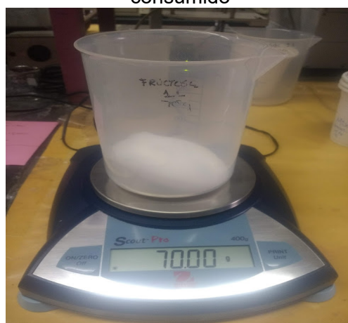
Figura A5.4. Ejemplo de pesaje de edulcorante (fructosa) en la balanza analítica
