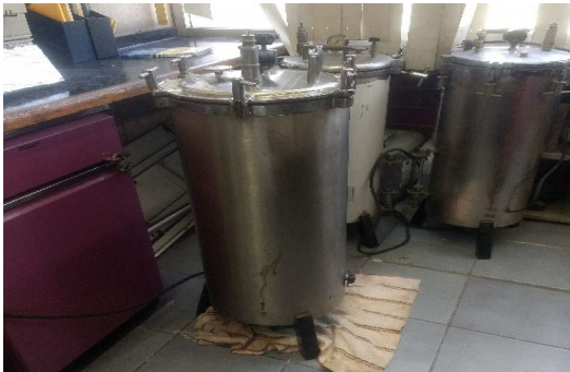
Figura A5.9. Autoclave utilizada para esterilizar los bebederos en el Laboratorio 301 del Conjunto E, FQ-UNAM
