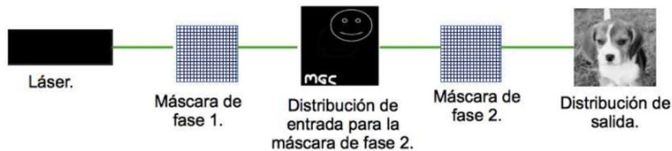
Figura 5.22: Montaje experimental para probar las máscaras de fase fabricadas
