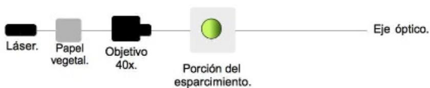
Figura 5.7: Montaje experiencial con modificaciones en los elementos ópticos.
