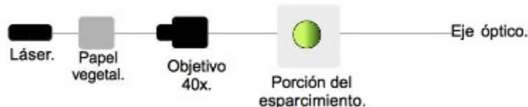
Figura 5.1: Montaje experimental utilizado para obtener la imagen de entrada.
