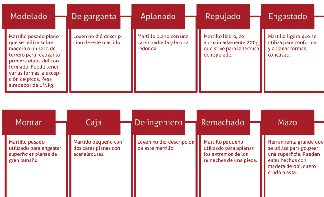
Figura 9. De la descripción de los tipos de martillo según Luyen, 1980
