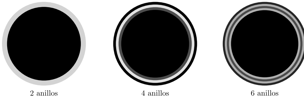
Fig. 3.8 Pantallas nulas de fase con diferentes números de anillos para un doblete cementado centrado en \lambda_E = 0.543\mu\text{m} .
