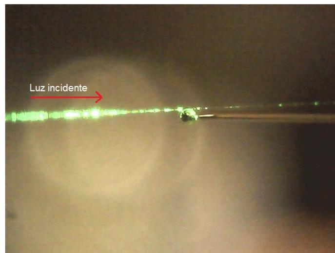
Figura 2.19: Muestra el acoplamiento entre la microesfera y la fibra adelgazada de la luz proveniente de un láser con una longitud de onda de 532 nm
