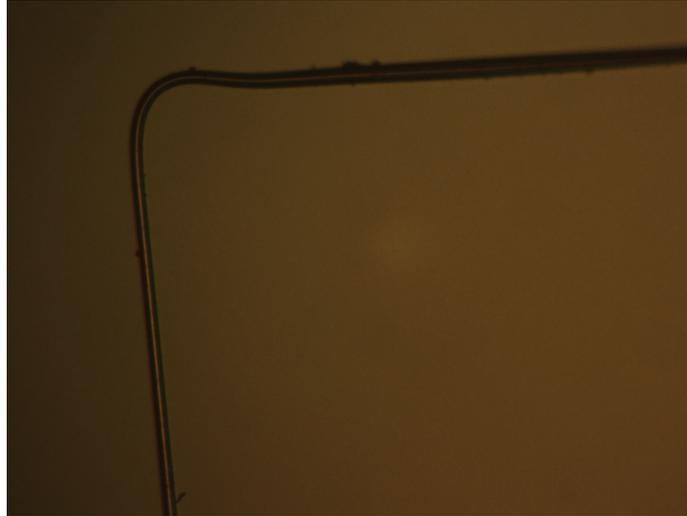
Figura 3.4: Una de las primeras fibras ópticas T3, que se intentó adelgazar pero que al igual que las anteriores sufrió una ruptura
