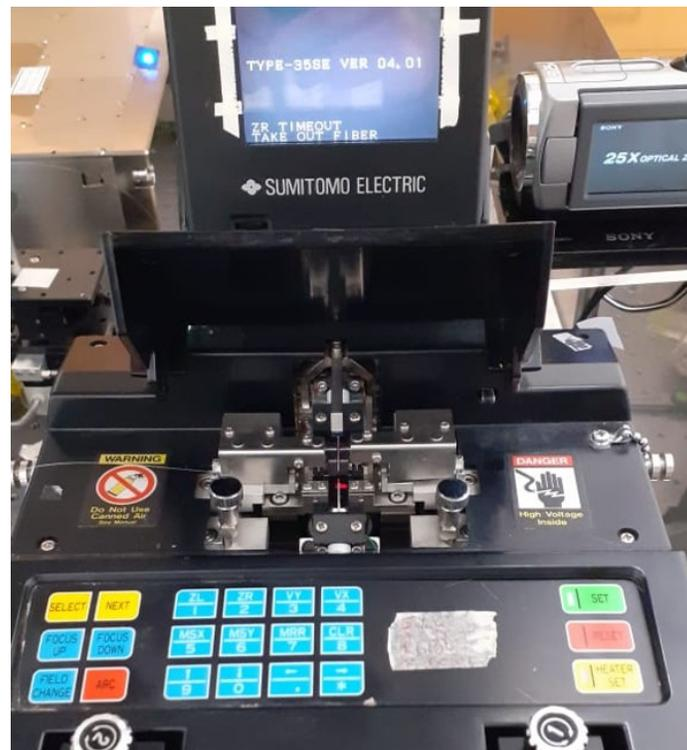
Figura 2.5: muestra la forma como se coloca la fibra óptica en la fusionadora óptica previamente limpiada y sin el recubrimiento polimérico también es posible ver el electrodo donde se genera el arco eléctrico.
