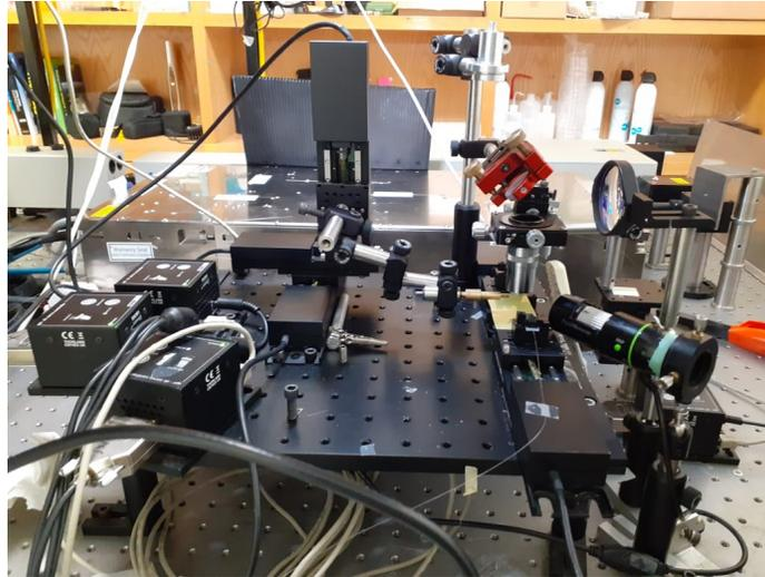
Figura 2.24: Sistema implementado con dos camaras para el adelgazamiento de la fibra óptica
