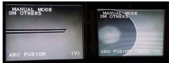
Figura 2.7: La fotografía de la izquierda muestra la fibra adelgazada en la fusionadora óptica y la fotografía de la derecha muestra la fibra ya transformada en una microesfera.
