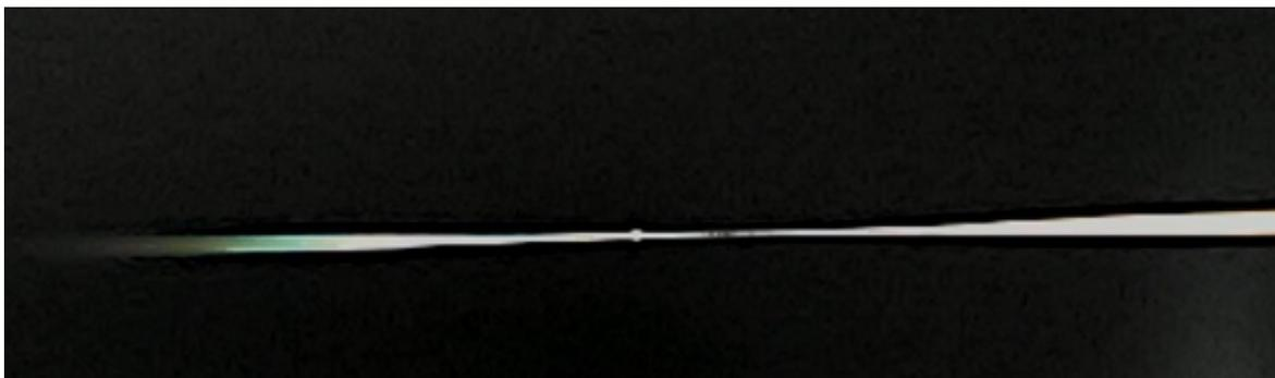
Figura 3.11: Fibra adelgazada donde incluso es posible observar diferentes colores sobre la fibra óptica ahusada
