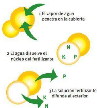
Figura 6. Mecanismos de actuación de los fertilizantes de liberación lenta
