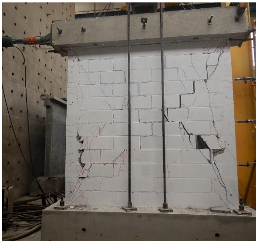
Figura 5.6 Patrón de agrietamiento final y curva de histéresis MBC-2
