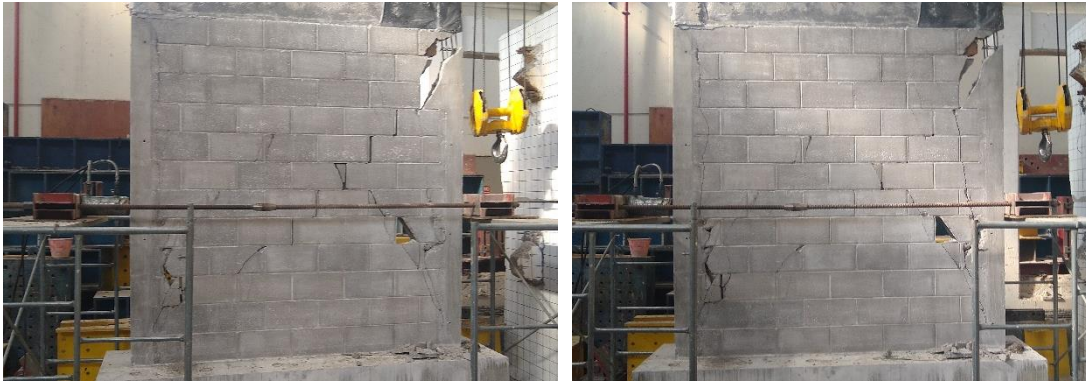
Figura 4.3 Cerramiento del MBC – 2 por posible inestabilidad
