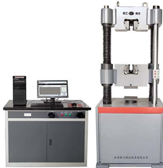
Figura 5. Ejemplo de máquina empleada en la realización del ensayo de tensión.
