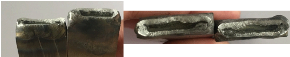
Figura 28. Ruptura de las probetas de tensión soldadas a distintas condiciones.
