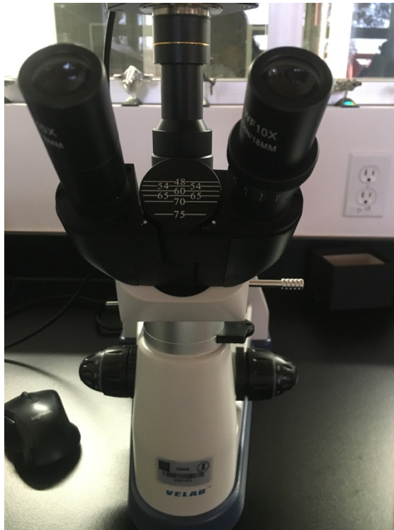
Figura 10. Microscopio empleado en el análisis microestructural de las soldaduras.
