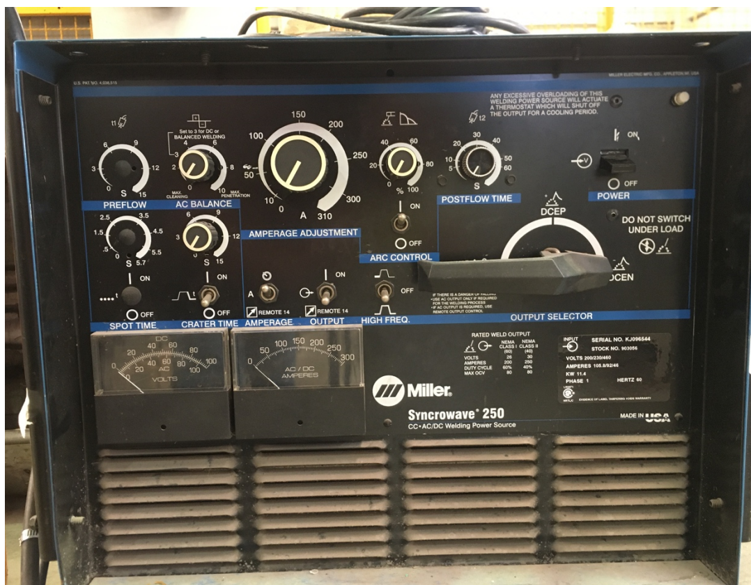
Figura 8. Planta de soldadura Syncrowave 250.
