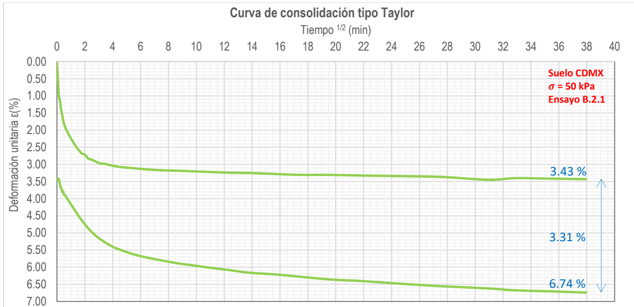
Figura 87. Curva tipo Taylor durante la consolidación del ensayo B.2.1
