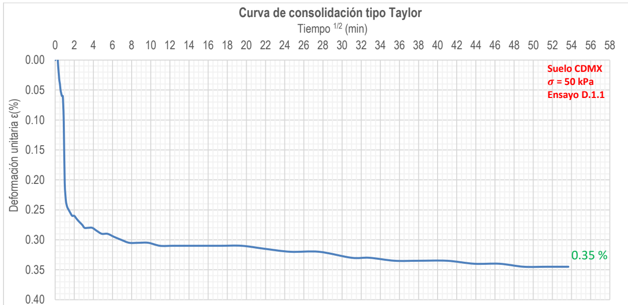
Figura 27. Curva tipo Taylor durante la consolidación poscíclica del ensayo D.1.1
