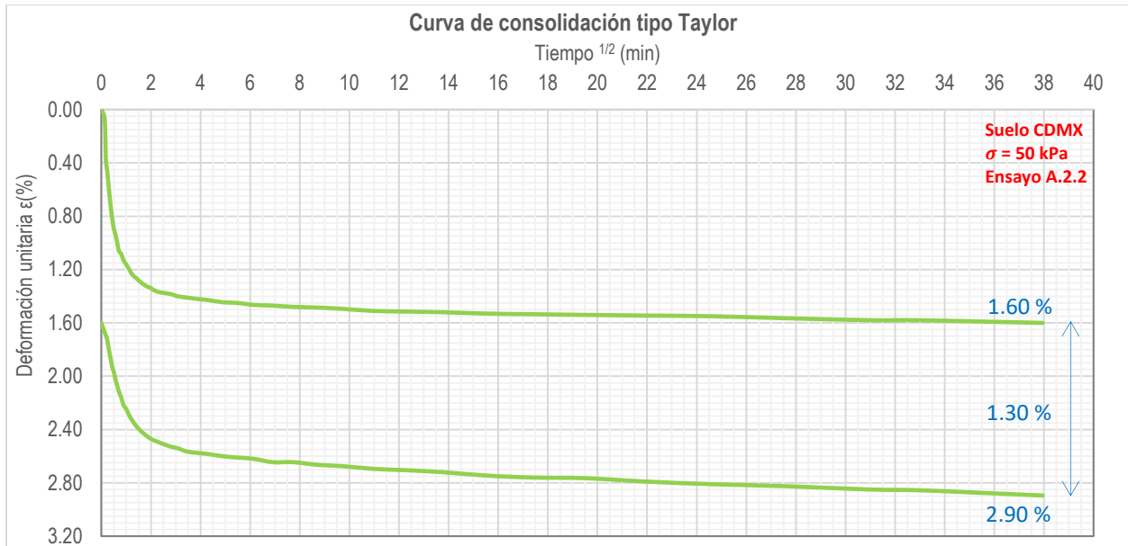
Figura 73. Curva tipo Taylor durante la consolidación del ensayo A.2.2
