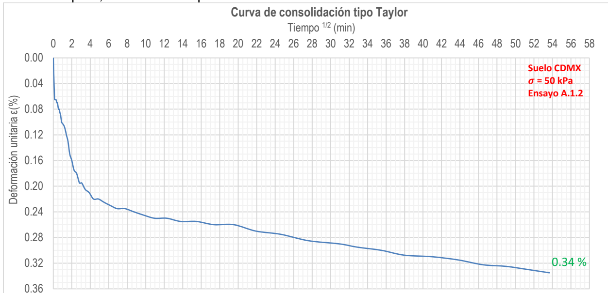
Figura 62. Curva tipo Taylor durante la consolidación poscíclica del ensayo A.1.2
