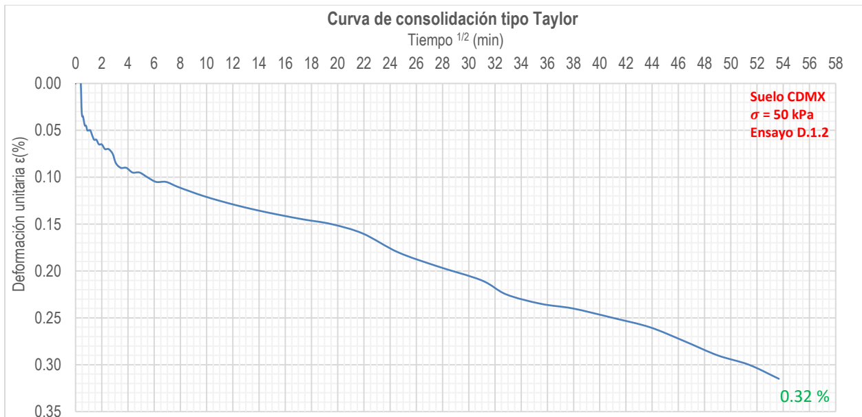
Figura 34. Curva tipo Taylor durante la consolidación poscíclica del ensayo D.1.2
