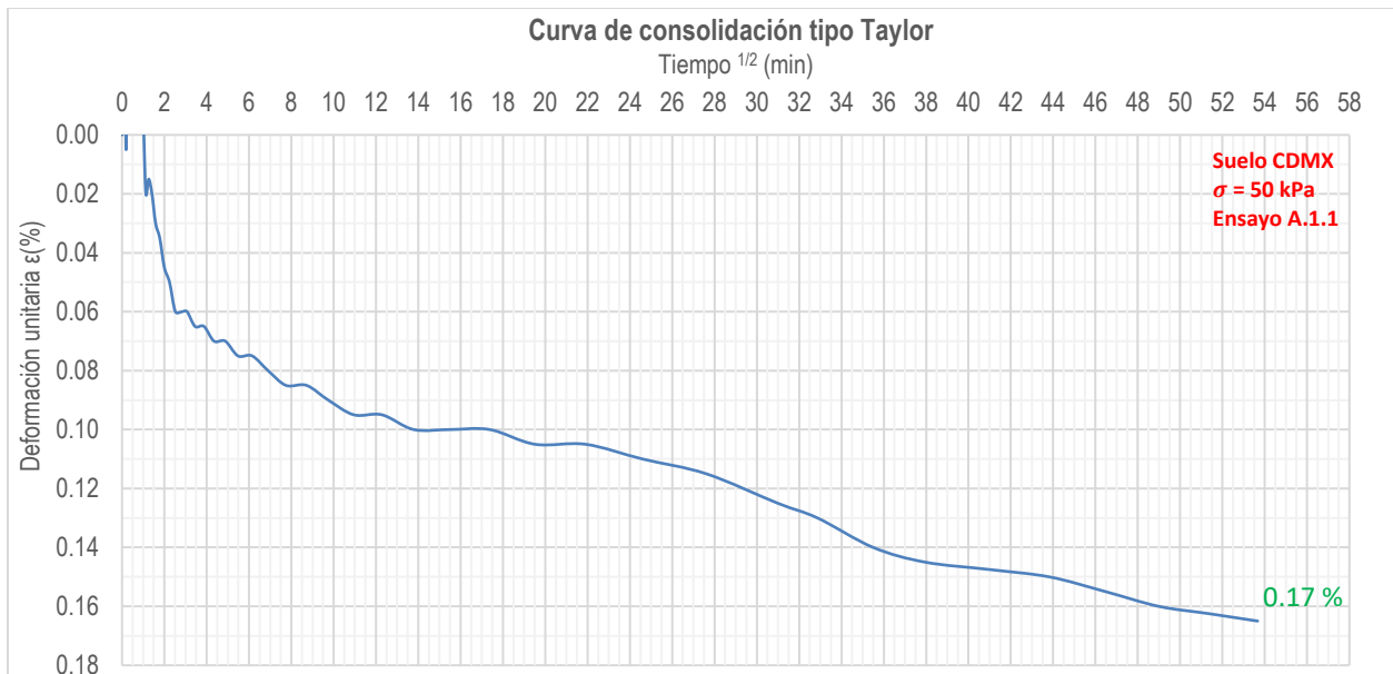
Figura 55. Curva tipo Taylor durante la consolidación poscíclica del ensayo A.1.1
