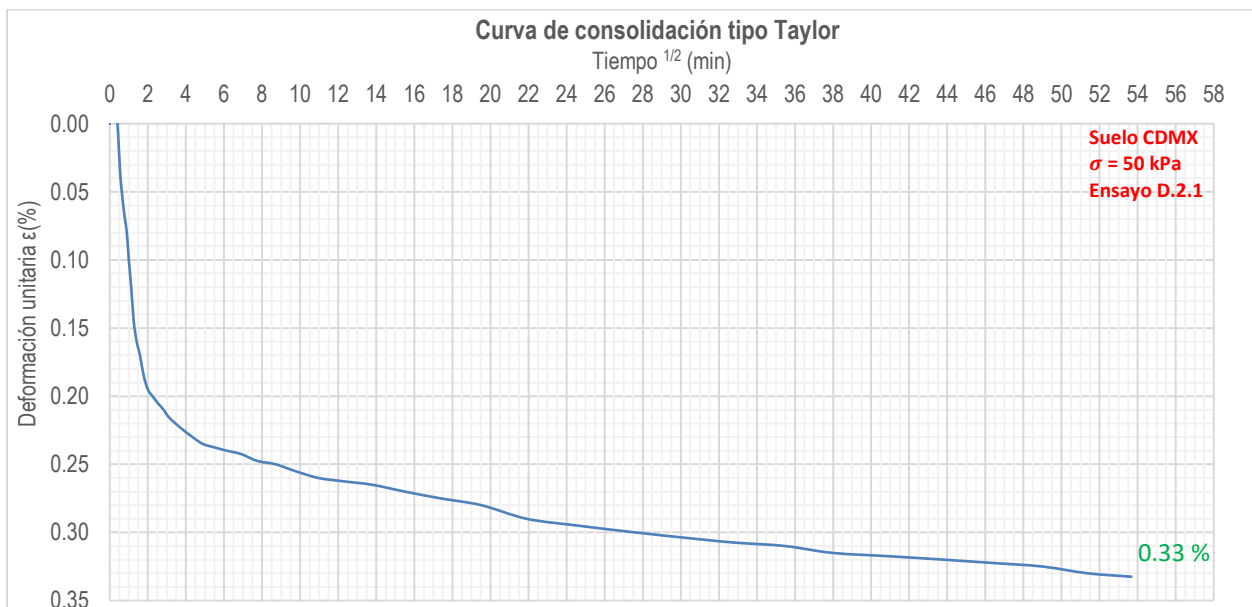
Figura 41. Curva tipo Taylor durante la consolidación poscíclica del ensayo D.2.1
