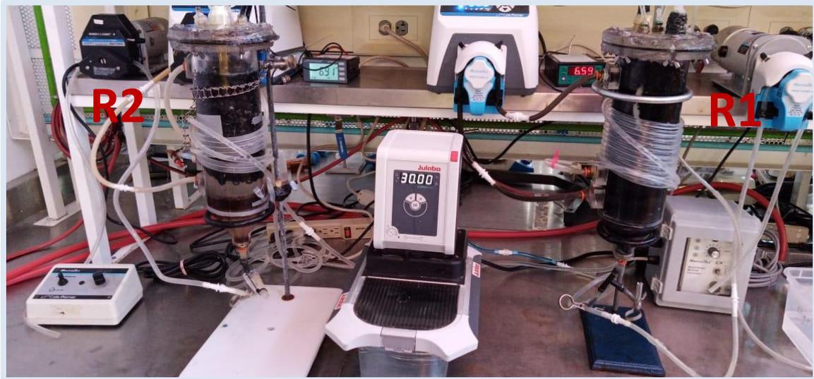
*Figura 4. 4. Reactores ensamblados: R1. Reactor de sulfato reducción; R2. Reactor de reducción desasimilatoria*
