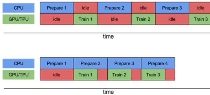
Figura 3,5. Diagrama precarga del lote de entrenamiento forma paralela
