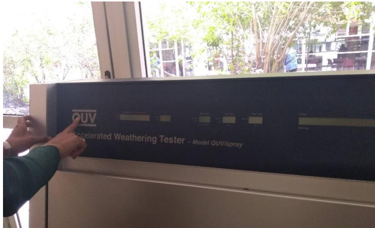
Figura 37. Equipo QUV/Spray para simulación de radiación UV.
