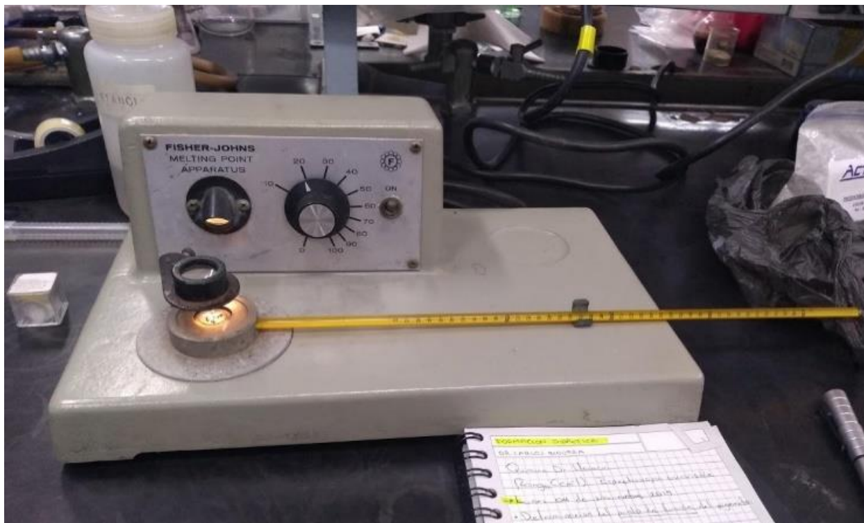
Imagen 38.- Aparato Fisher Jonhs. Laboratorio de Posgrado Facultad de Química UNAM.
