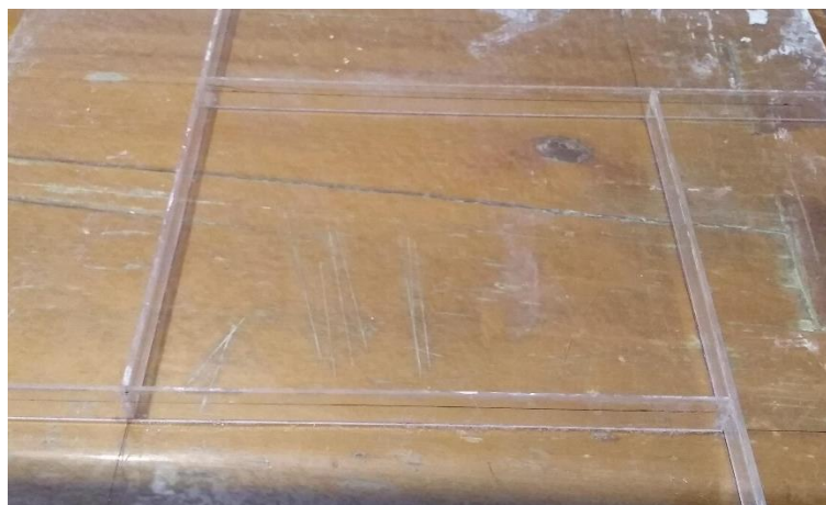
Figura 30. Molde de acrílico con 6 mm de espesor, para colado de muestras.
