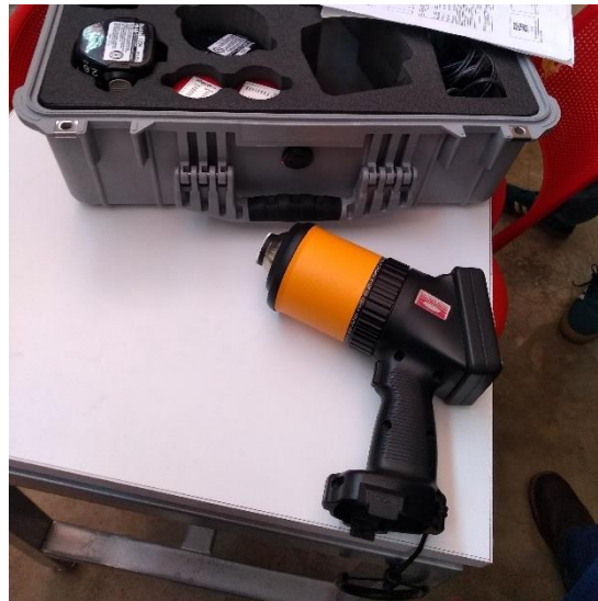
Figura 35. Reflectómetro 410-Solar visible. Laboratorio de Entornos Sostenibles, Facultad de Arquitectura, UNAM.
