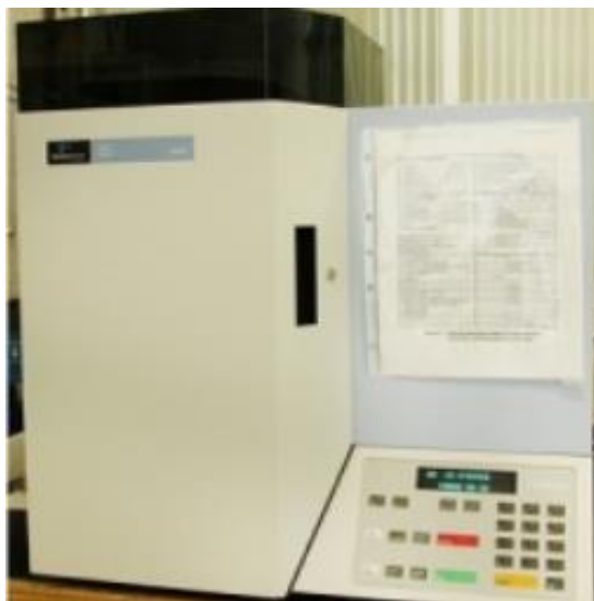
Imagen 40.- Micro analizador elemental CHNS, con sistema de detección de Micro TruSpec de LECO.
