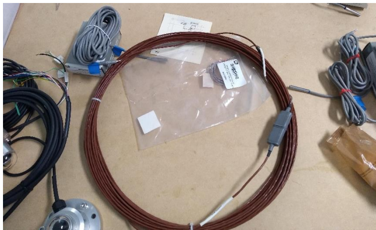
Figura 32. Sensores de contacto (termopares tipo k) para medir temperatura superficial.
