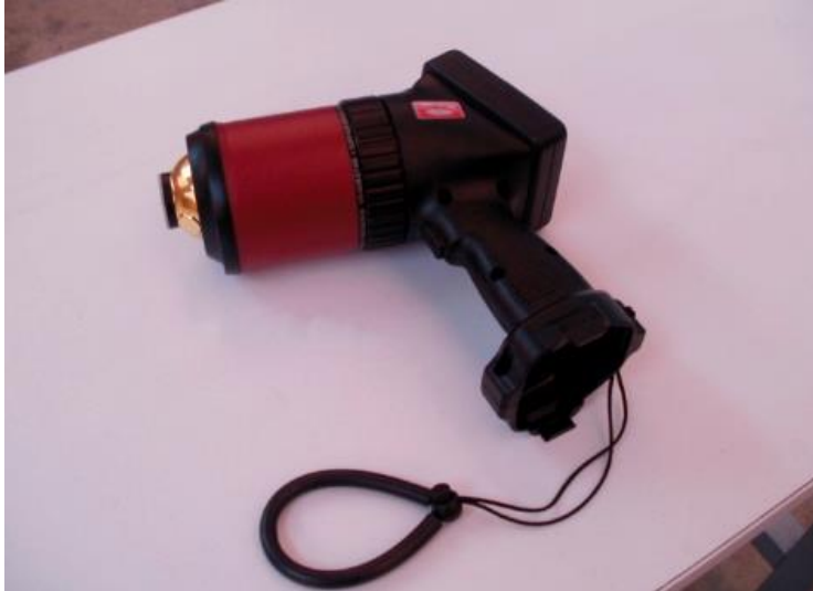
Figura 36. Emisómetro térmico de mano ET100. Laboratorio de Entornos Sostenibles, Facultad de Arquitectura, UNAM.
