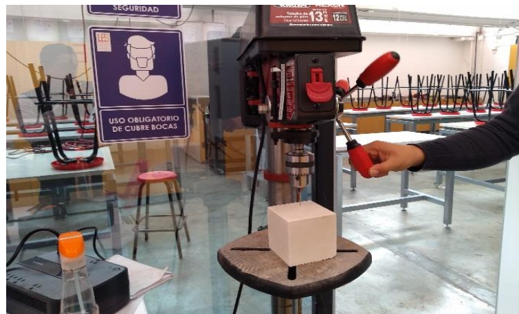
Figura 34. Muestras cúbicas de 10 centímetros sobre equipo de barrenación.
