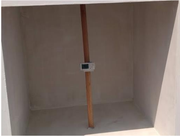
Imagen 47. Colocación de dispositivo HOBO modelo U-10 en el interior del módulo de prueba para monitoreo de la temperatura interior.
