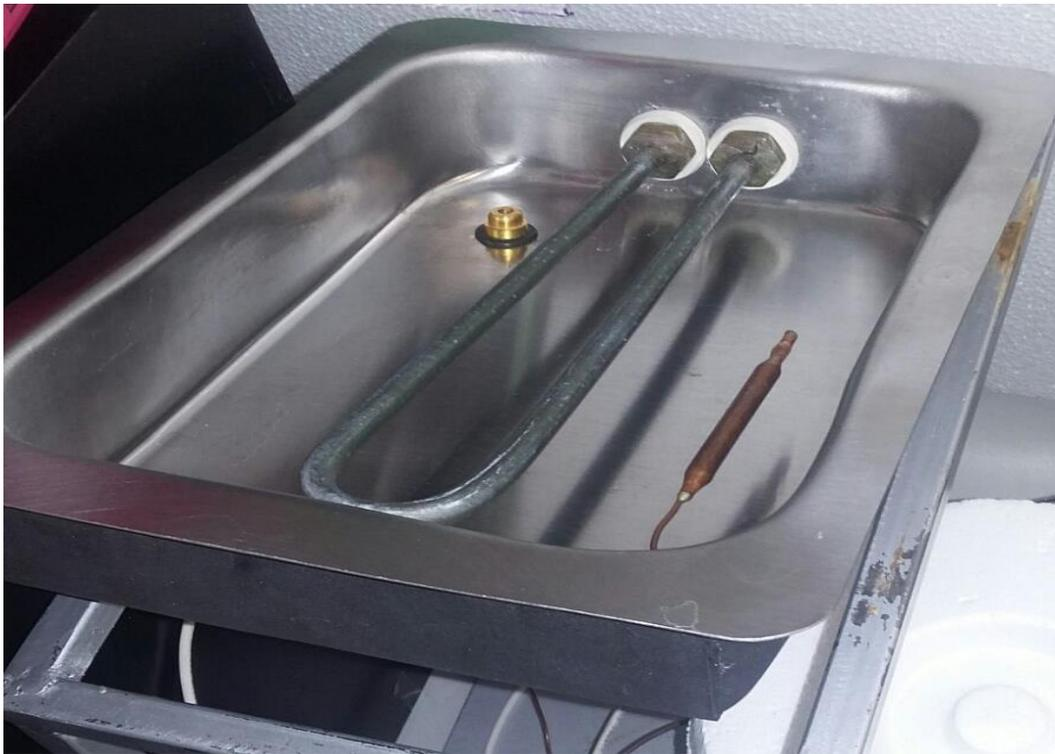
**Figura 19.** Montaje de los componentes para el sistema de calentamiento.
