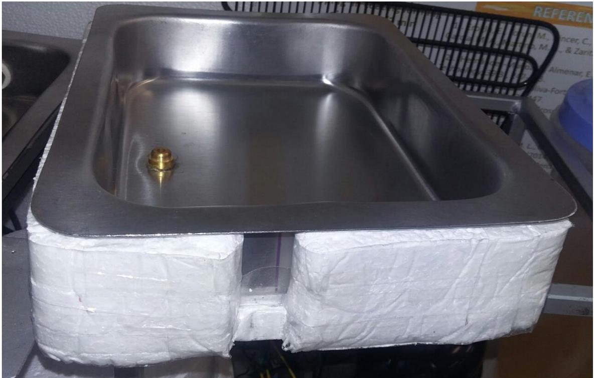
**Figura 22.** Aislamiento térmico (Polietileno expandido) recipiente de enfriamiento.
