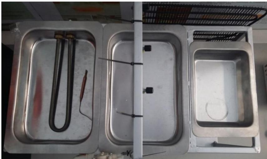
Figura 2. Vista superior del equipo, donde se representan las tres zonas: calentamiento, enfriamiento y escurrimiento.
