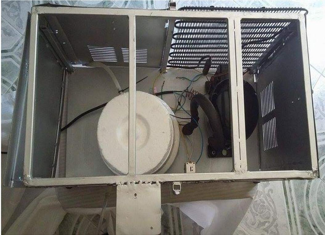
**Figura 26.** Vista superior del equipo, que muestra el interior.
