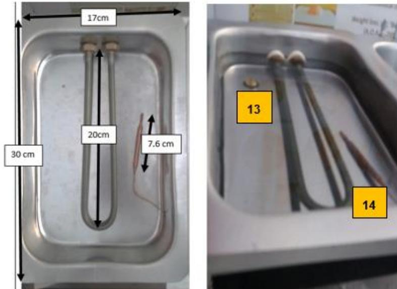
**Figura 7.** Identificación de partes del recipiente de calentamiento y medidas.
