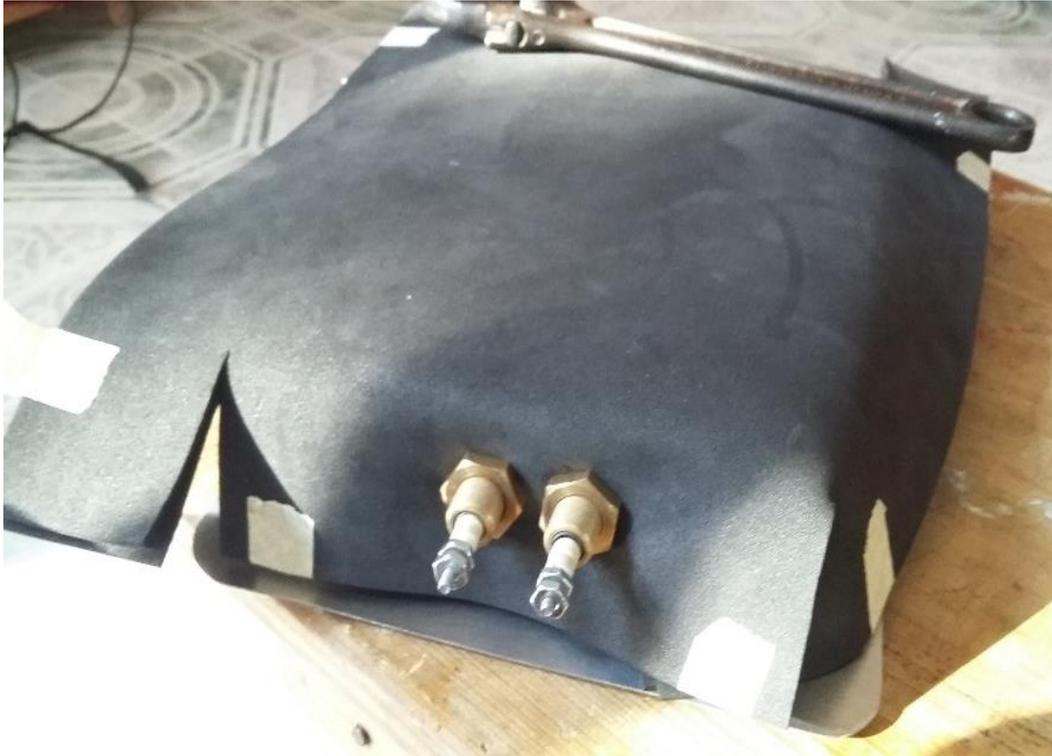
**Figura 20.** Aislamiento térmico (Etilvinilacetato) del recipiente de calentamiento.
