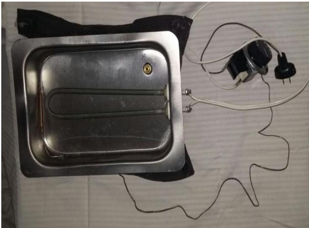
**Figura 18.** Instalación eléctrica del sistema de calentamiento.
