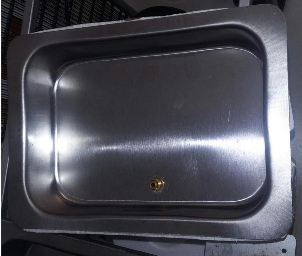
**Figura 21.** Recipiente de enfriamiento con desagüe de agua.
