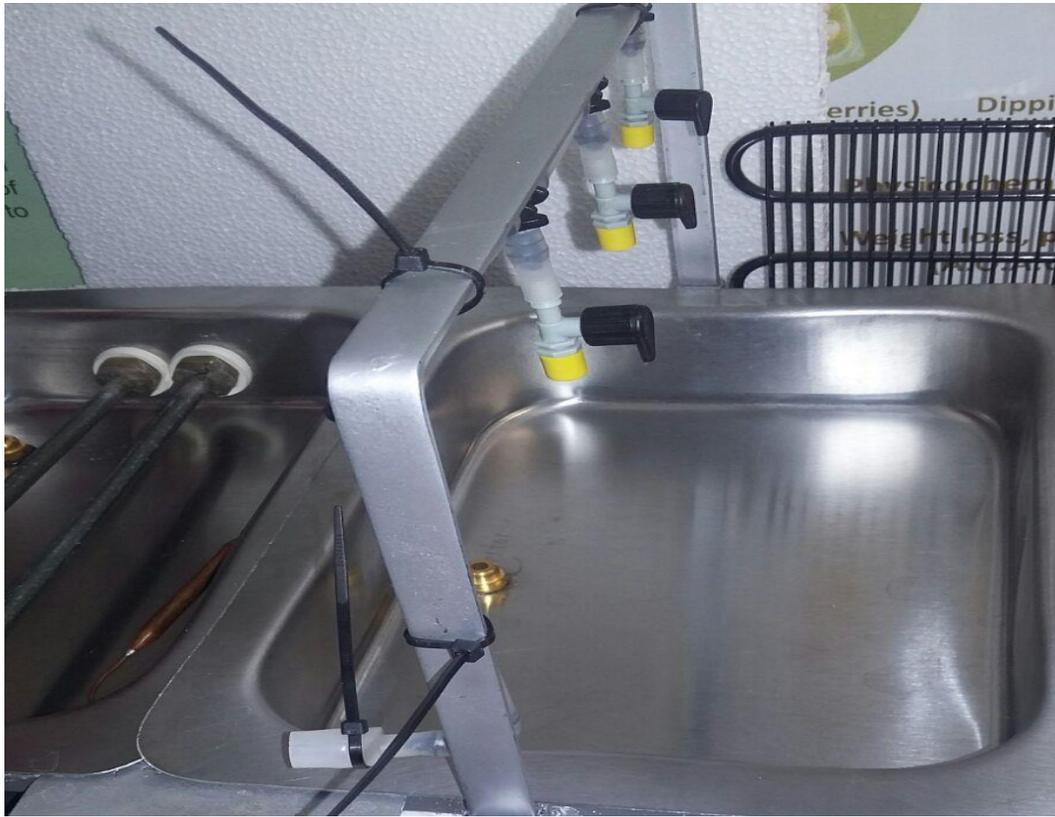
**Figura 25.** Instalación de tubería para el transporte de agua del evaporador a los aspersores.
