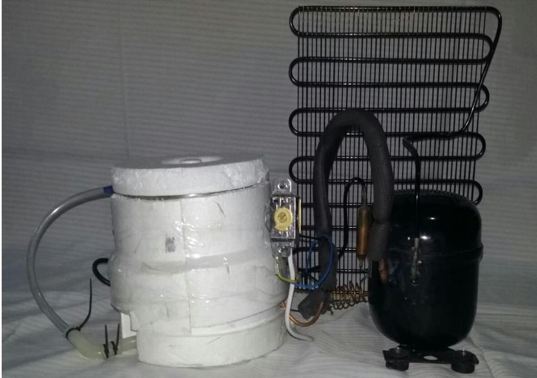
**Figura 23.** Unidad condensadora completa.
