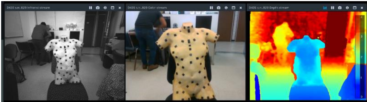
Figura 16- Pruebas de escaneo con software de la cámara Intel Real Sense.
