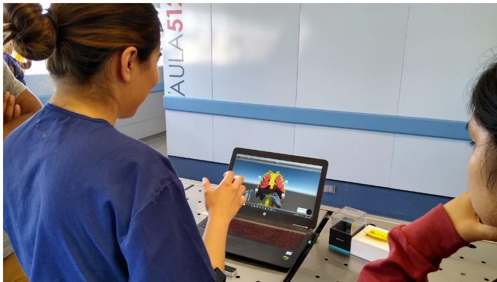
Figura 45- Primeras pruebas de interacción con alumnos de la Facultad de Medicina, utilizando únicamente la pulsera Myo y el sensor Leap Motion.
