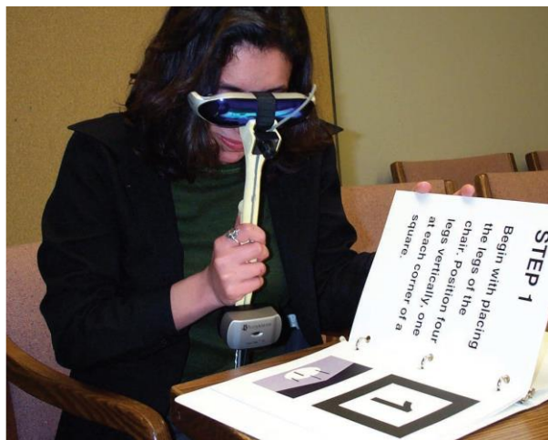
Figura 10- Magic Book , libro con visualizador que consiste de una pantalla portátil Sony Glasstron para proyectar imágenes del libro (Billinghurst et al., 2001).
