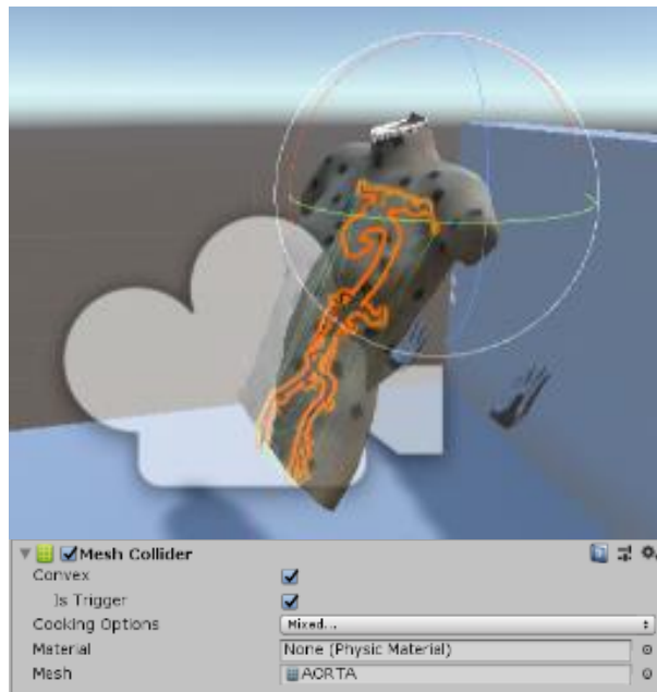
Figura 35- Mesh Collider en la Aorta y panel Hierarchy con las propiedades del Mesh Collider.
