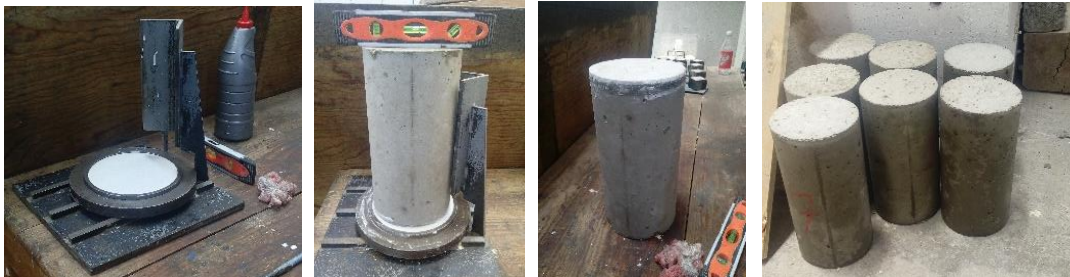
Figura 4.47. Cabeceo de cilindros de concreto
