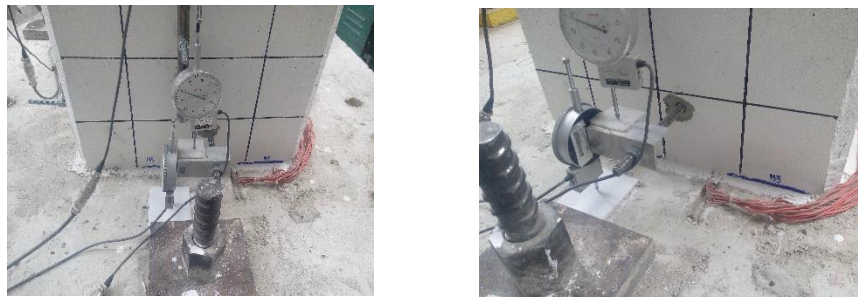
Figura 5.1. Primeras grietas de flexión cara Este
