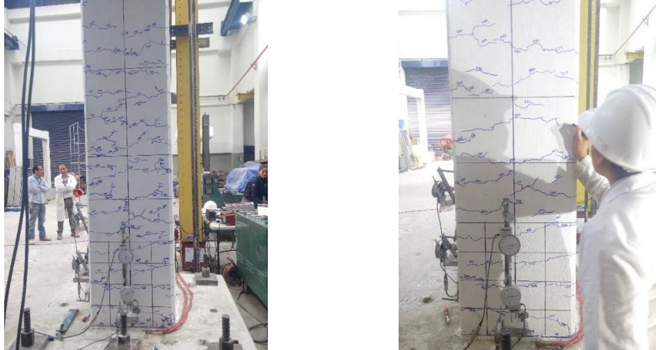
Figura 5.2. Patrón de grietas de flexión cara Este MC-1
