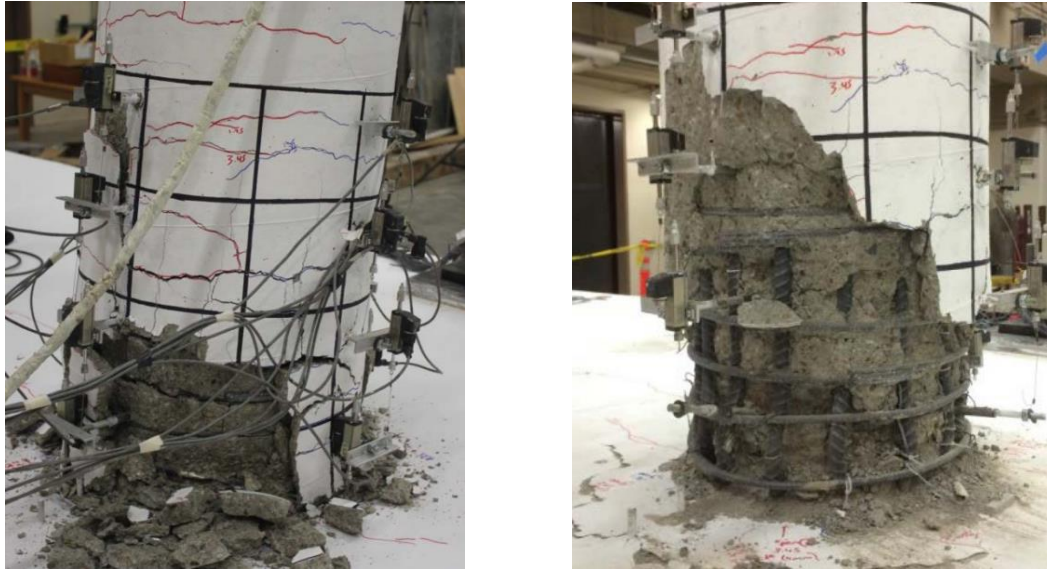
Figura 2.11. Desconchamiento del recubrimiento de columnas (Moustafa et al. , 2015)
