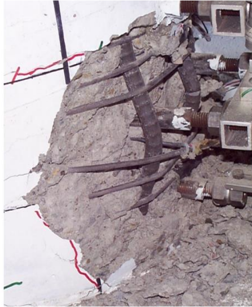
Figura 2.12. Pandeo del refuerzo longitudinal (Hachem et al. , 2000)
