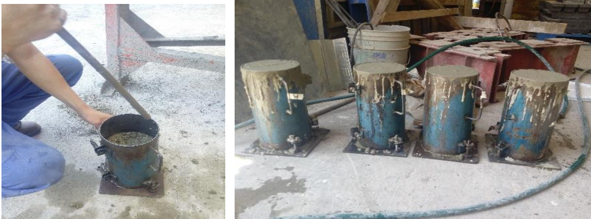
Figura 4.28. Toma de muestras de concreto para pruebas de resistencia
