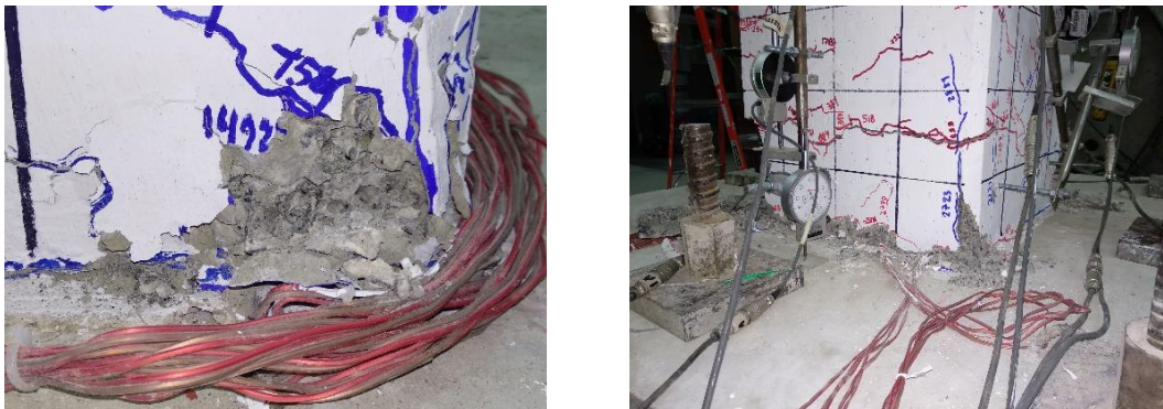
Figura 5.5. Aplastamiento y desconchamiento del concreto de espécimen MC-1
