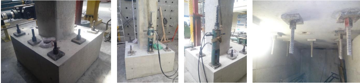
Figura 4.42. Sistema de fijación de los especímenes a la losa de reacción
