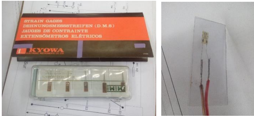
Figura 4.29. Deformímetros eléctricos (strain gages)
