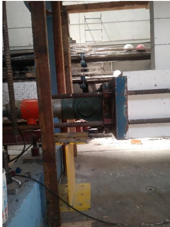
Figura 19. Detalle de la conexión del actuador inferior
