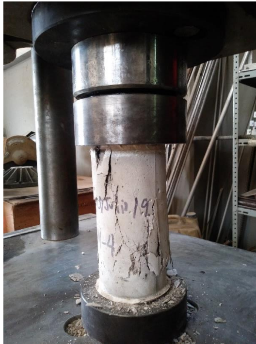
Figura 22. Pruebas de cilindros de concreto
