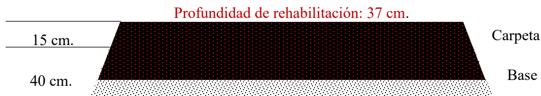
Figura 19. Profundidad de rehabilitación del Escenario 2.
