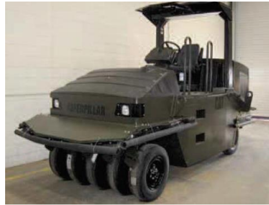
Figura 15. Compactador de neumáticos caterpillar PS150C (Caterpillar, 2010).
