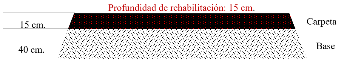
Figura 18. Profundidad de rehabilitación del Escenario 1.
