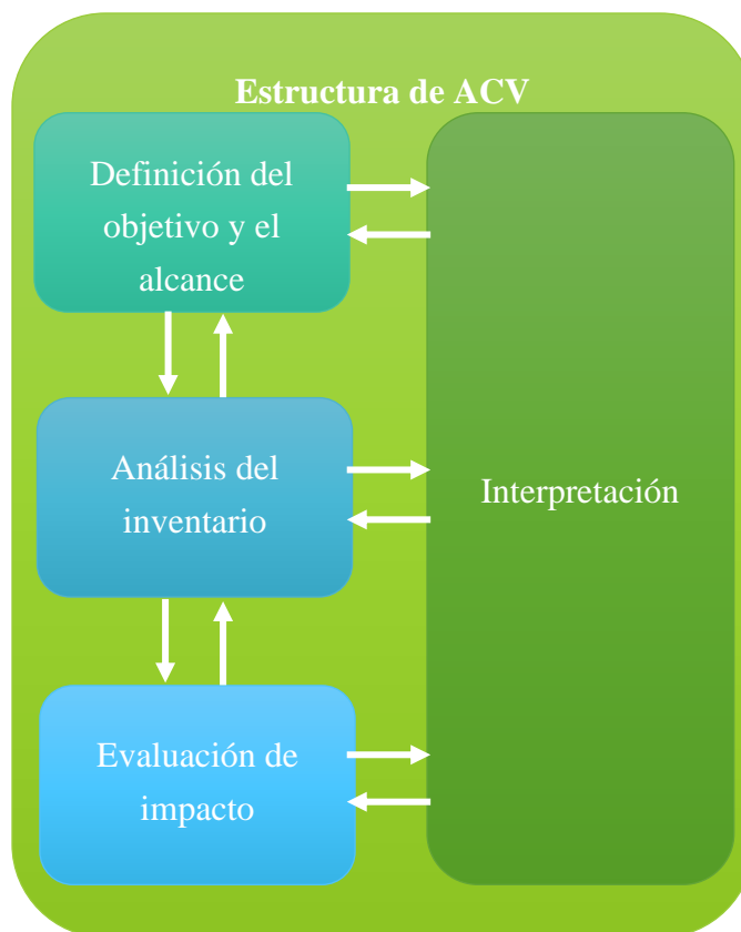
Figura 6. Estructura de un Análisis de Ciclo de Vida. Fuente: adaptado de ISO 14040 Fuente: adaptado de (ISO,2006).
