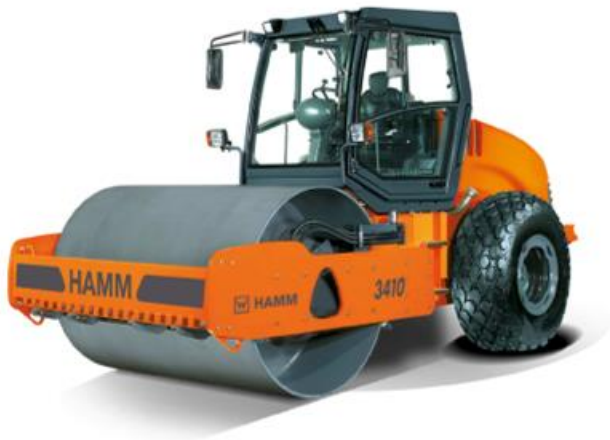
Figura 14. Compactador vibratorio liso Hamm 3410. (HAMM, s/f).
