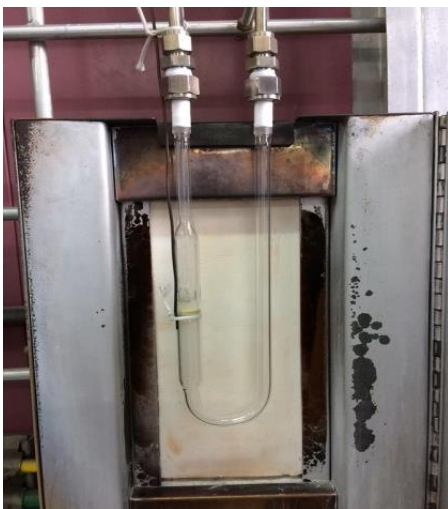
Figura 24. Reactor tubular en forma de "U" empleado para la activación de los catalizadores.
