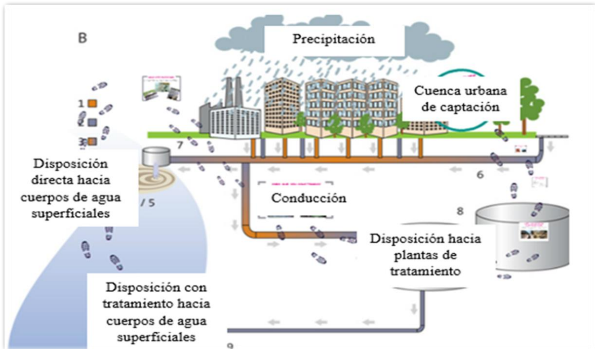
Figura 2. Esquema de un sistema de drenaje pluvial.
