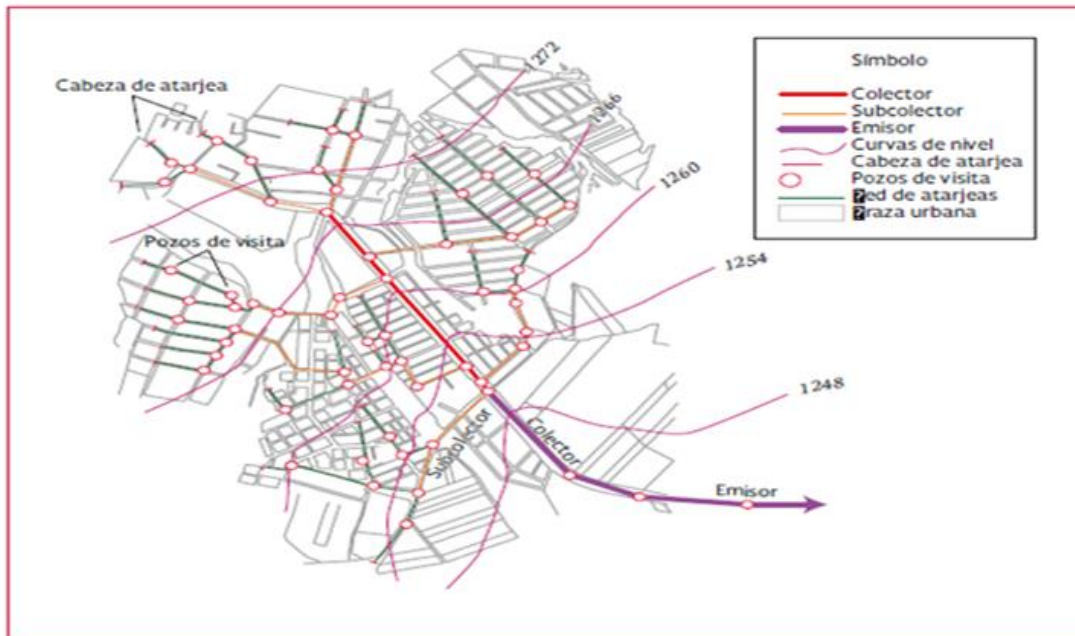
Figura 9. Modelo en abanico del trazo de colectores. (Comisión Nacional del Agua, 2016, pág. 10)
