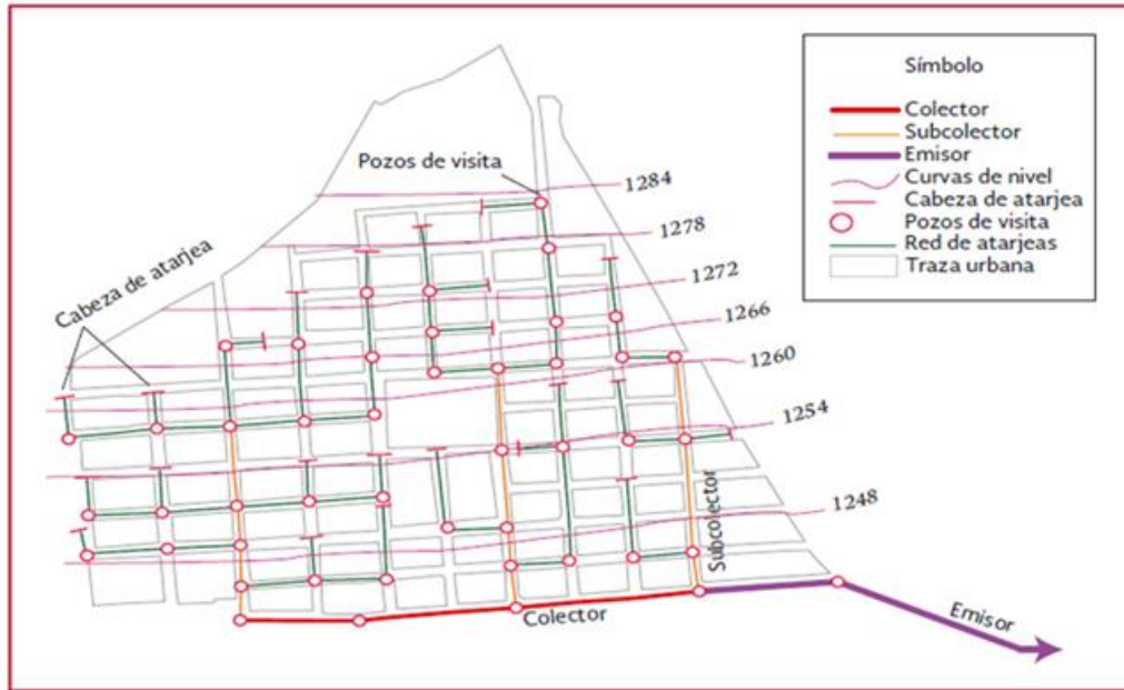
Figura 8. Modelo de interceptores para colectores. (Comisión Nacional del Agua, 2016, pág. 9)
