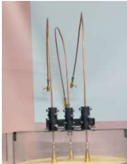
Figura A.9 Tapa implementada para la alineación y soporte de quemadores.
