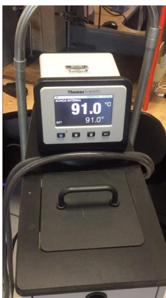
Figura 26. Bomba de recirculación Thomas Scientific para mantener un flujo constante a 90 ° C
