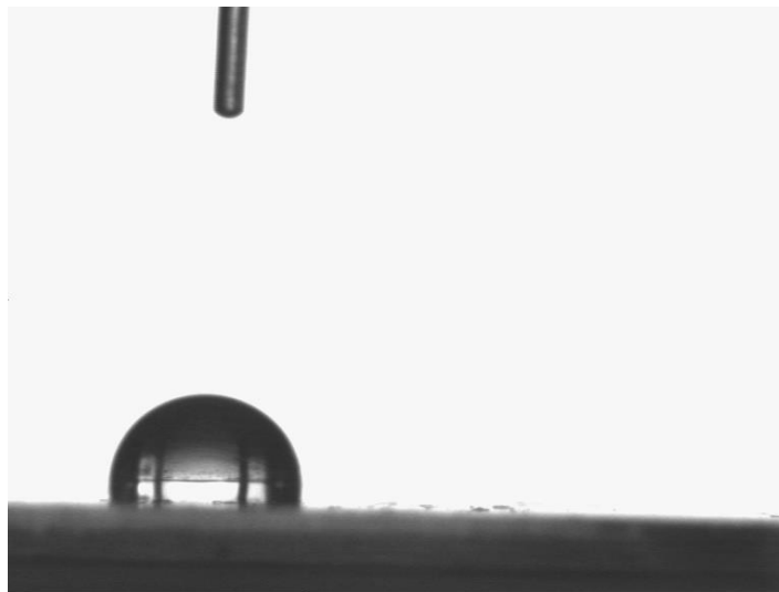
Figura 37. Ángulo de contacto en un tubo anodizado más fluoropolímero
