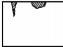
Figura 5. Corrosión por picaduras [8]
