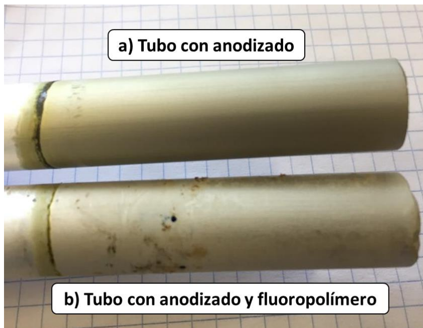
Figura 21. Comparación de tubos de aluminio anodizado a) anodizado sin fluoropolímero, b) anodizado con fluoropolímero
