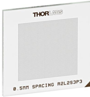
Fig. 3.2 Placa de calibración con un patrón cuadrangular de puntos para la calibración [18].
