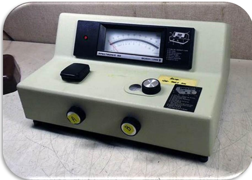
Figura 37 Medición de la absorbancia del Cromo (III)
