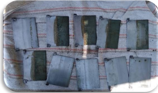
Figura 10 Placas después de un tratamiento por electrocoagulación
