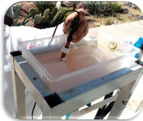
Figura 27 Zona de reacción:-: medición de pH antes del tratamiento
