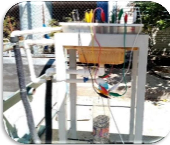
Figura 13 Conexión del sistema de electrocoagulación
