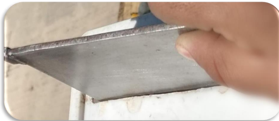
Figura 24 Electrodo de hierro previo al proceso (placa limpia)
