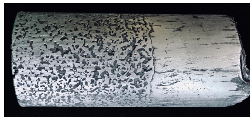
Figura 2.7. Lingote de aleación y preforma de NaCl salido de crisol
