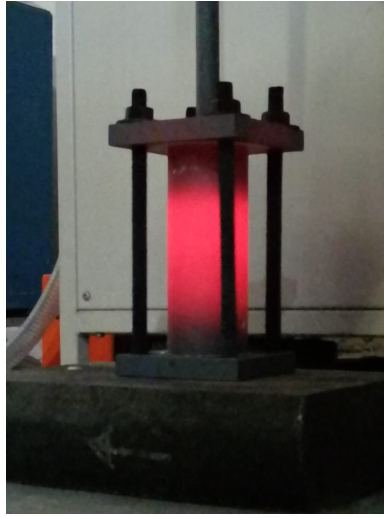
Figura 2.6. Crisol en enfriamiento sobre placa de Cu
