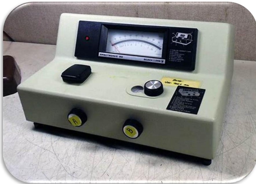
Figura 37 Medición de la absorbancia del Cromo (III)
