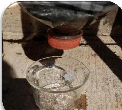
Figura 30 Proceso de filtración después del tratamiento por electrocoagulación
