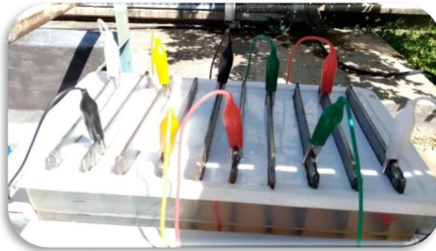
Figura 12 Colocación de los caimanes en las placas de hierro (electrodos)
