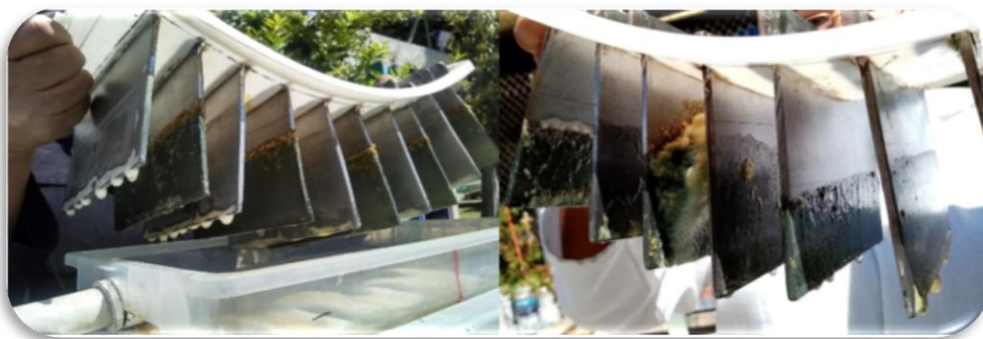
Figura 15 Placas después del tratamiento de electrocoagulación
