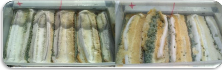
Figura 29 Natas formadas durante el proceso de electrocoagulación
