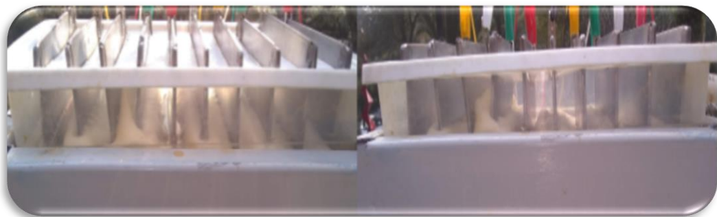
Figura 28 Electrodo de reacción: formación de espumas durante el proceso de electrocoagulación
