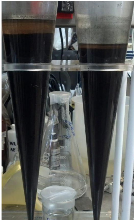
Figura 5. Sedimentación en cono Imhoff.
