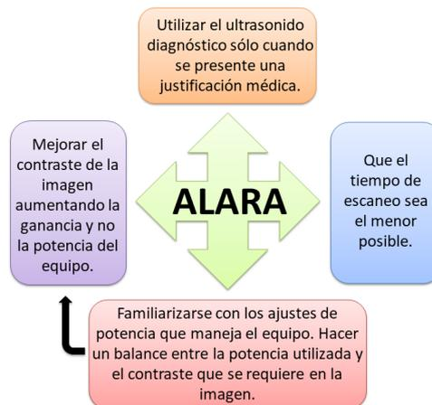
**Figura 2.16:** Puntos a considerar al momento de aplicar el principio ALARA en equipos de ultrasonido médico.
