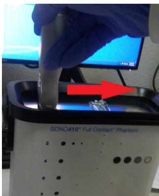
**Figura 3.9:** Movimiento del transductor sobre el maniquí para generar el barrido. En este caso se utilizan la ventana plana para transductores lineales.
