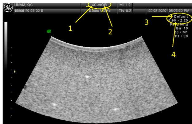
**Figura 3.2:** En una imagen de ultrasonido aparecen los ajustes que se le aplican al escáner.
