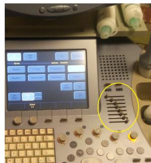
**Figura 3.4:** Perillas del TGC se muestran dentro del círculo amarillo.
