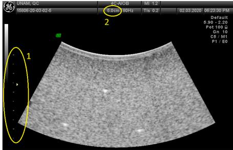
**Figura 3.5:** (1) Escala que nos indica la profundidad. A lado de la misma se presenta el punto triangular que nos indica el foco, (2) Valor numérico de la profundidad.
