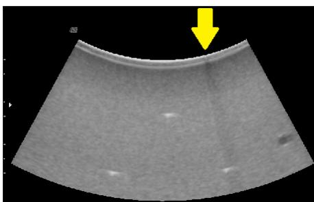
**Figura 3.12:** Imagen suavizada resultante que se obtiene al promediar todas las imágenes adquiridas. En este caso, el procesamiento revela una sombra vertical (identificada por la flecha amarilla) que puede ser causada por elementos piezoeléctricos deficientes.
