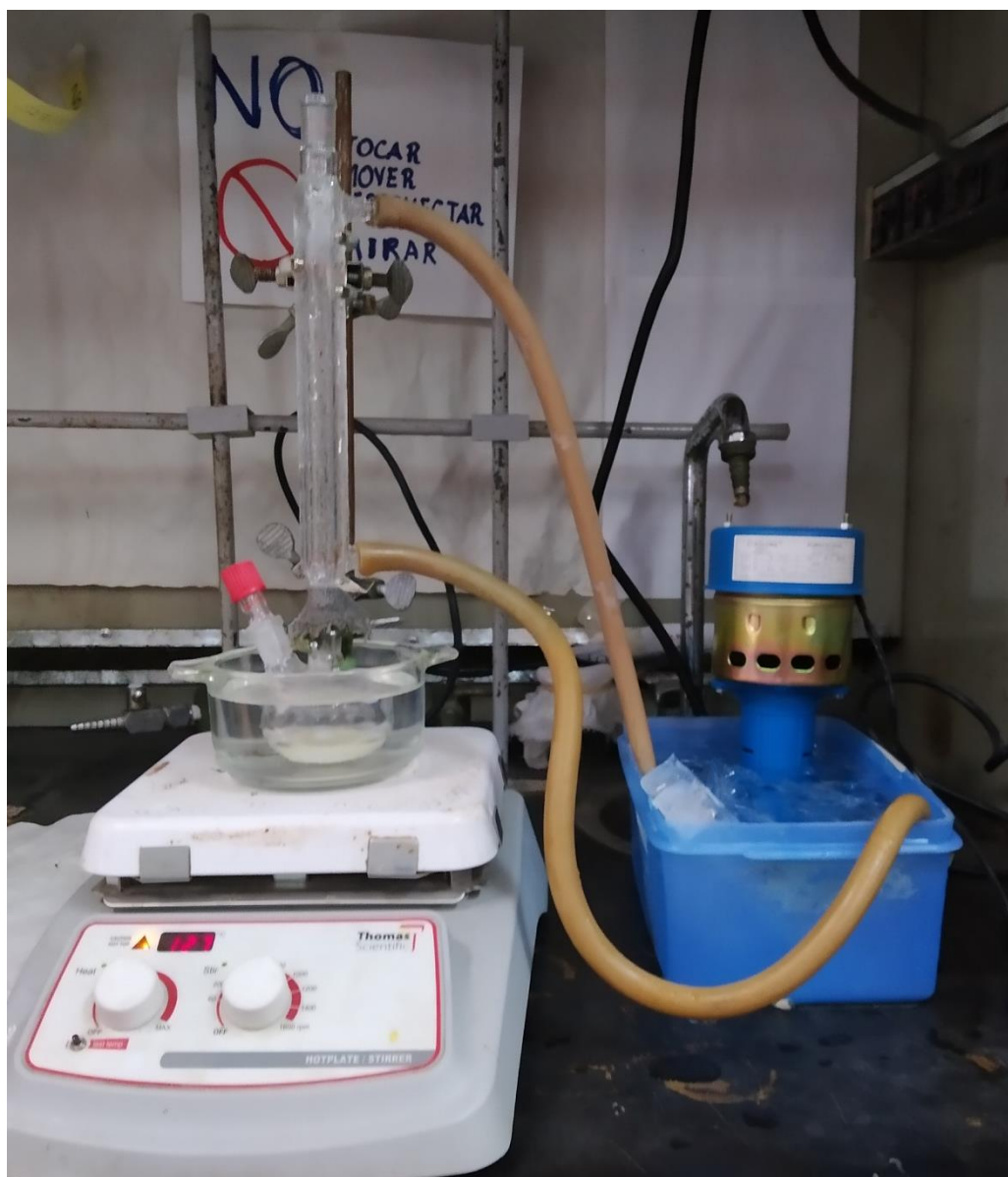
Figura 4. Montaje de equipo para la reacción de transesterificación
