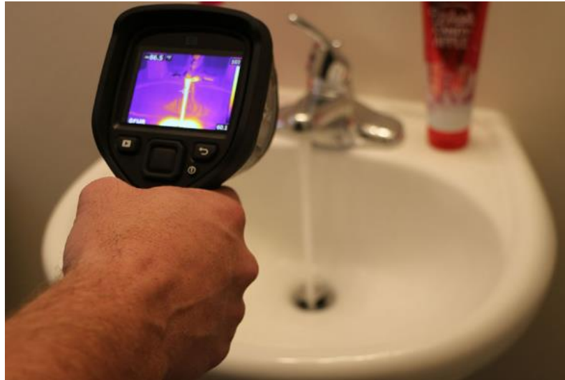
Figura 4. Cámara infrarroja, detectando agua a temperatura elevada saliendo del grifo.
