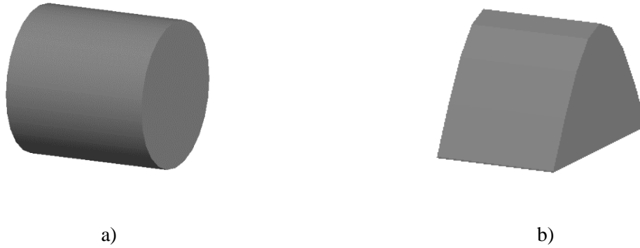
Figura 2.12. Maniqués utilizados para la caracterización del prototipo PEM-IFUNAM. a) Maniqué cilíndrico. b) Maniqué con forma de mama comprimida que está compuesto de un conjunto de cuñas.
