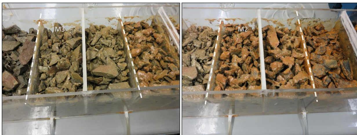
Figura 6.12 Recubrimiento de la roca caliza con los sedimentos de hierro en los módulos M2 y M3 durante la prueba 1 con el prototipo inicial.
