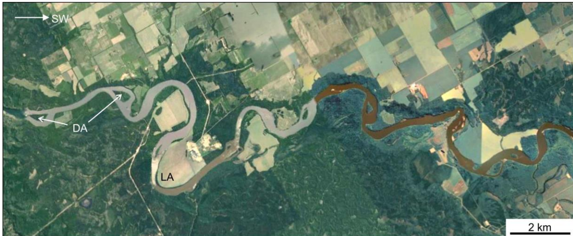
Figura 10.5 Fotografía satelital de un segmento del río Athabasca, en Canadá, donde se observa una alta sinuosidad y también bifurcación de su corriente principal por la presencia de depósitos del elemento arquitectónico DA. También se observa el depósito del elemento LA en el interior de los meandros. Fotografía tomada de Google Earth.
