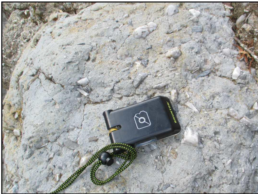
Figura 5.9 Fotografía de la Litofacies de Conglomerado Masivo Soportado por Matriz (Gci). La brújula tiene una longitud de 10 cm.
