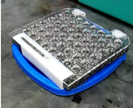
Figura 9. “Sándwich” para electrotransferencia
