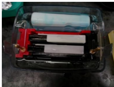
Figura 10. Equipo BioRad ® donde se realiza la electrotransferencia y un ejemplo de su funcionamiento (Lee, 2007)
