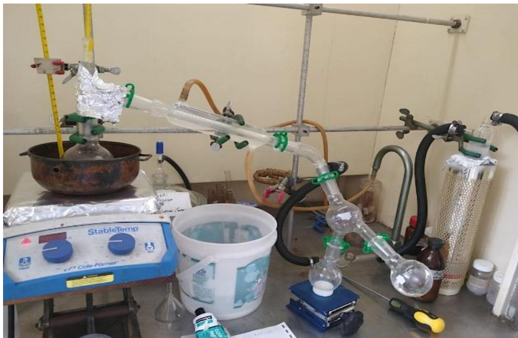
Figura 21. Montaje del sistema de destilación a presión reducida
