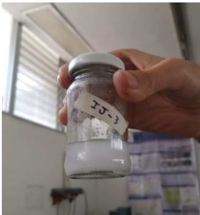
Figura 28. Muestra que tras tratarse experimentalmente presentó una capa de gel viscosa
