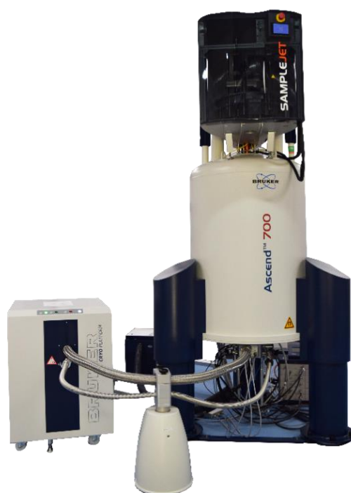
Figura 3. Espectrómetro Bruker Avance III de 16.44 Tesla (700 MHz para ^1\text{H} ).
