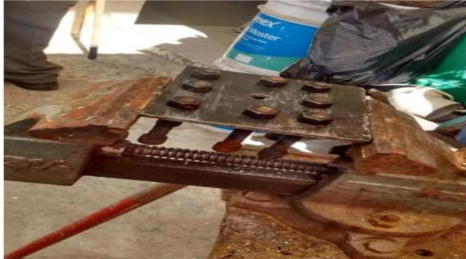
*Imagen 3.10, la placa seleccionada se le colocará las tuercas.*
