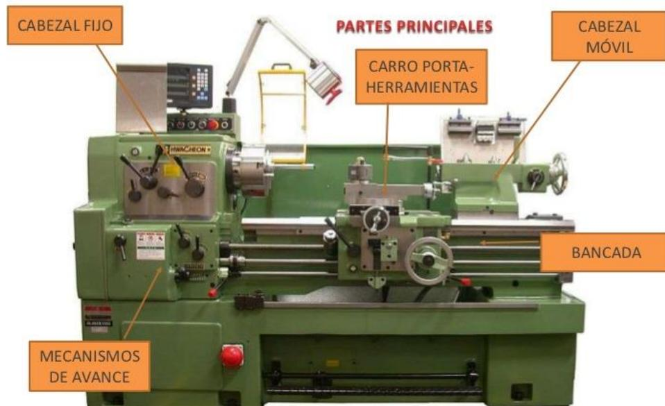
*Imagen 2.1, partes de un torno convencional, fuente ulhi.net.*
