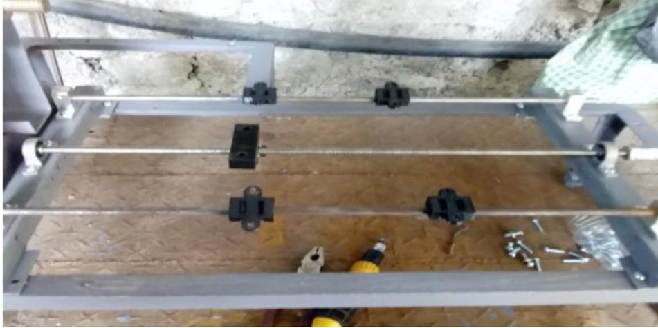
*Imagen 3.6, la unión de los 3 elementos para el carro longitudinal.*
