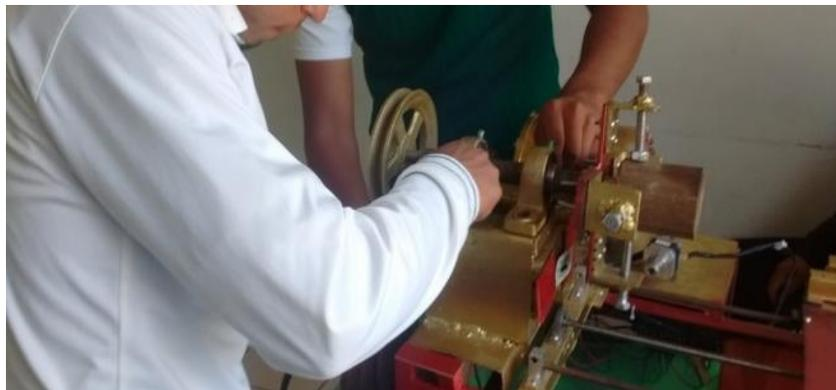
*Imagen 6.8, equipo 3, ensamblando Chuck y eje transversal.*
