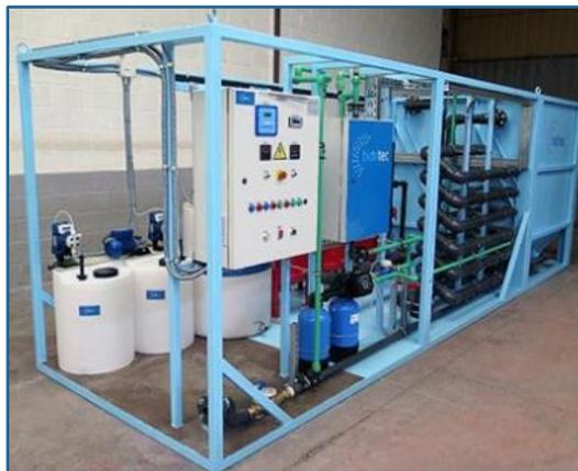
Figura 8. Equipo de dosificación de hipoclorito de sodio. Tomada de (Nuevo, 2018)
